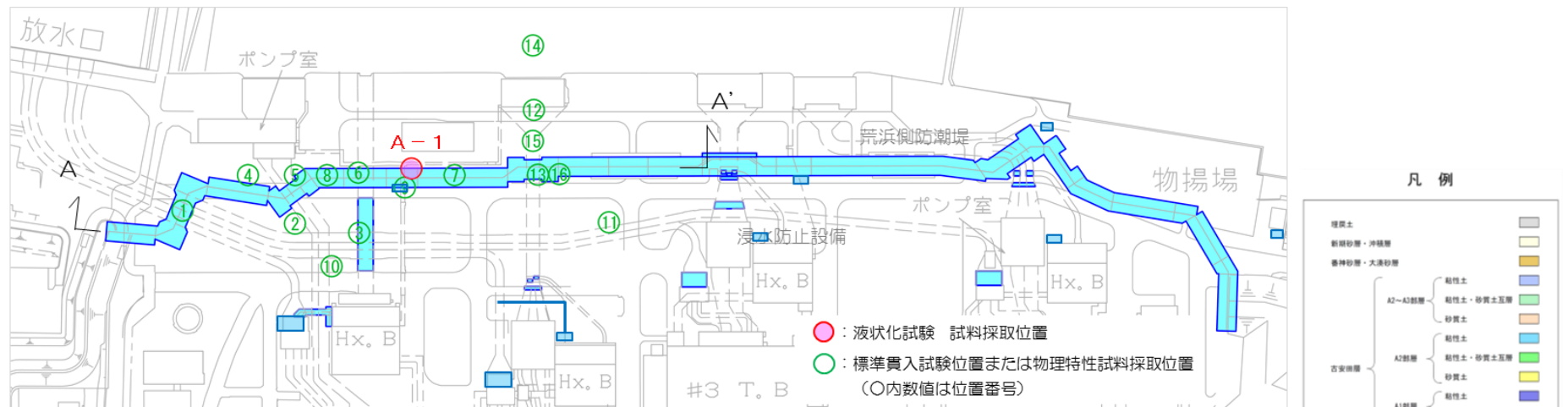
N値及び物理特性の調査位置図：荒浜側 A-1（洪積砂層 I）
