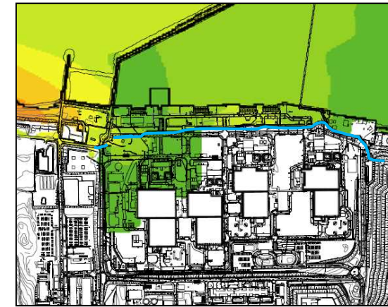
防潮堤損傷2 (1ブロックなシケース)
