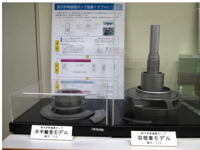
福島第二3号機 原子炉再循環ポンプ損傷トラブル
