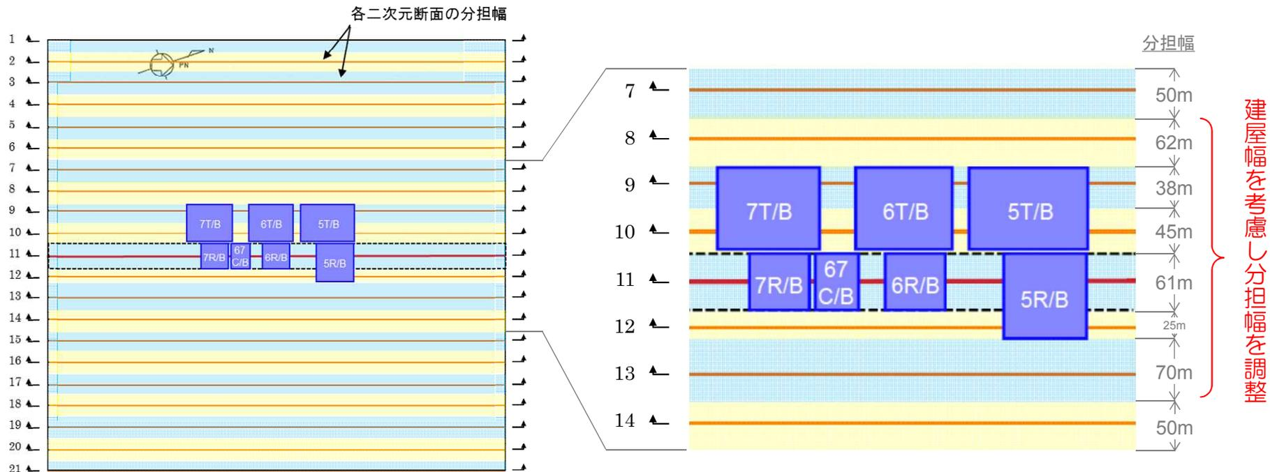
各二次元断面の負担幅図
