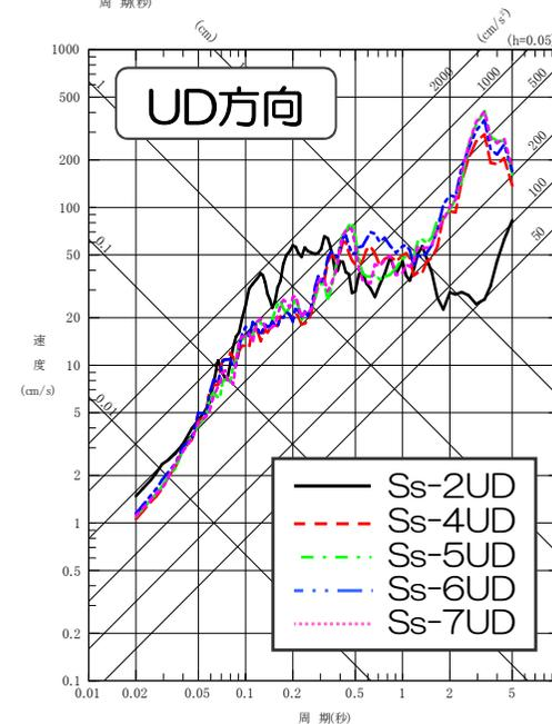
大湊側 入力地震動（基準地震動  $S_s$ ）の擬似速度応答スペクトル
