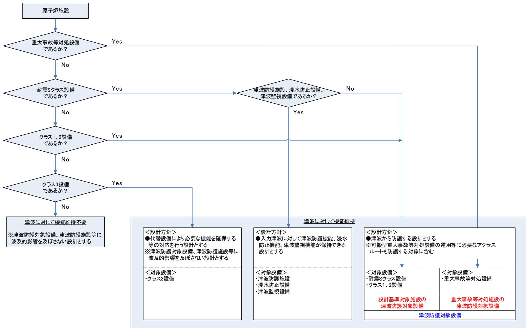
第 1.1-1 図 津波防護対象設備、津波防護設計方針選定フロー
