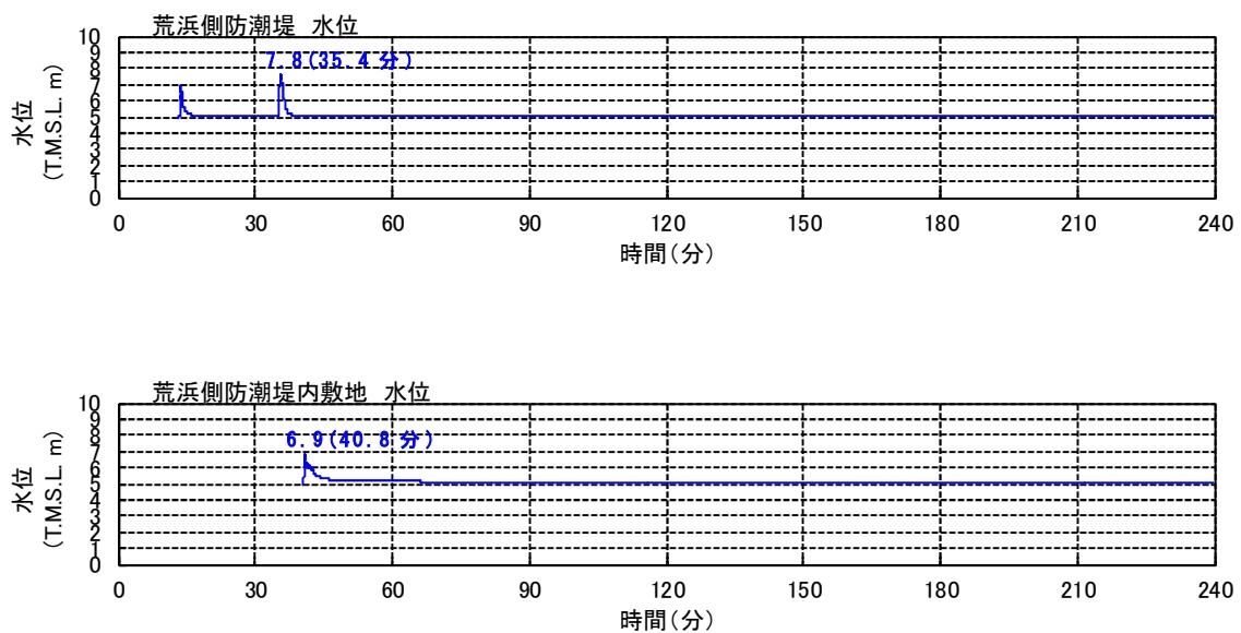
第 3-3 図 入力津波の時刻歴波形（荒浜側遡上域）
