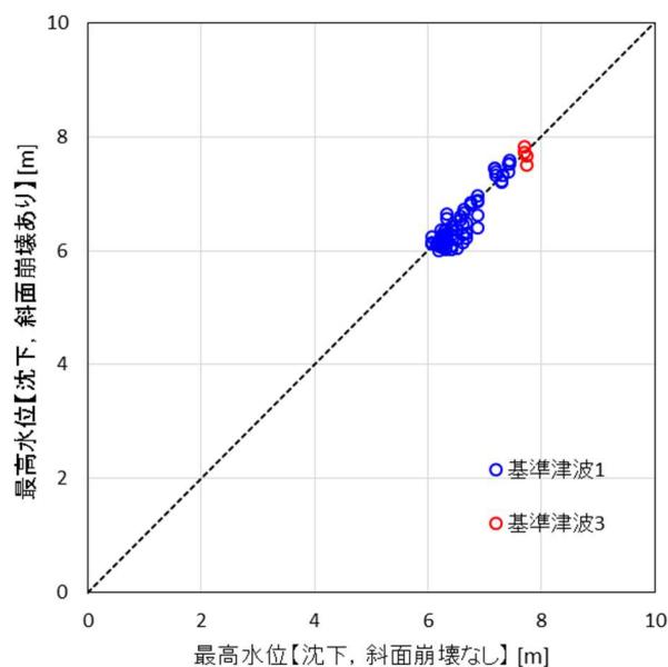
添付第 2-36 図 沈下・斜面崩壊の有無に対する水位比較
