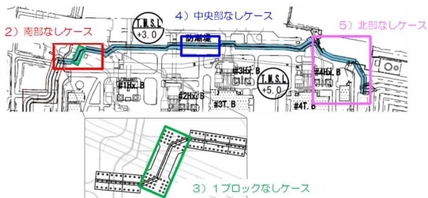
添付第 2-26 図 各検討ケースの防潮堤損傷状態
