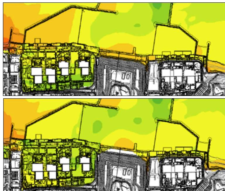
3) 敷地及び港湾付近 拡大図（上：沈下・斜面崩壊なし、下：沈下 2m・斜面崩壊あり）
