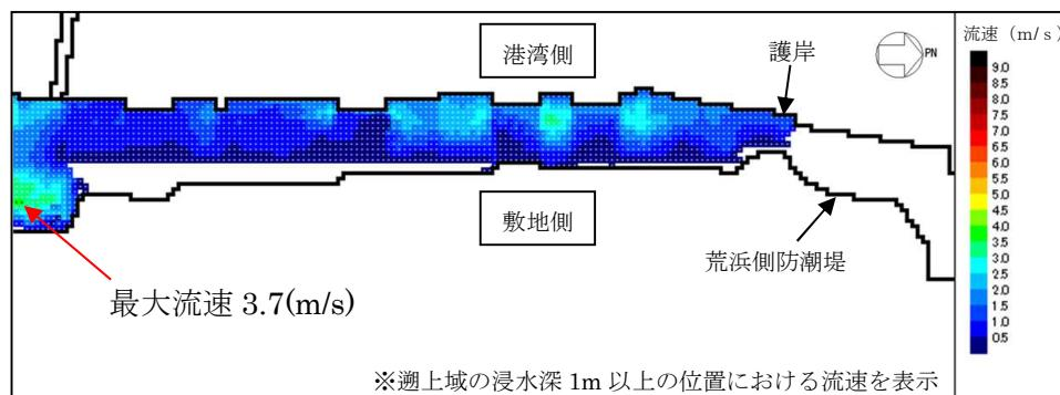
第15図 谷本式に対応する基準津波3の最大流速分布（荒浜側防潮堤直交方向）
