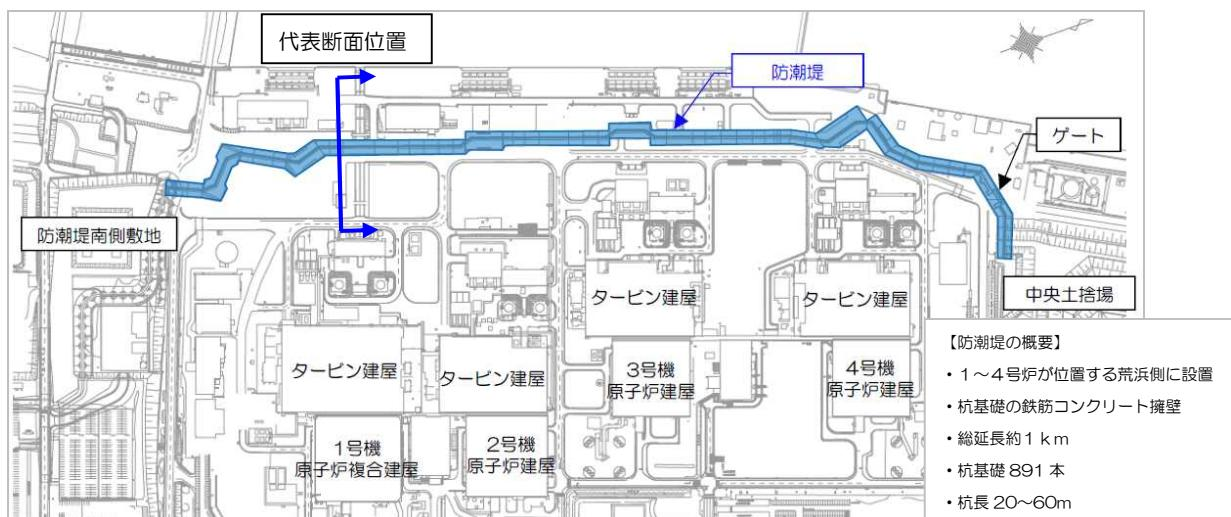
第 1 図 荒浜側防潮堤の概要
