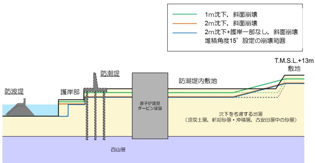
添付第 2-28 図 各検討ケースの沈下・斜面崩壊形状イメージ
