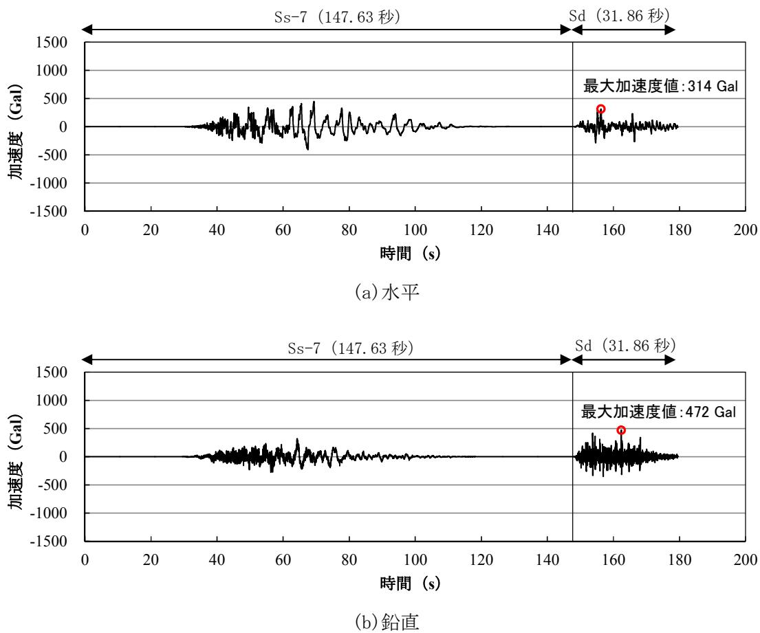
第 18 図 上部工重心位置での加速度応答 (Ss-7⇒Sd)
