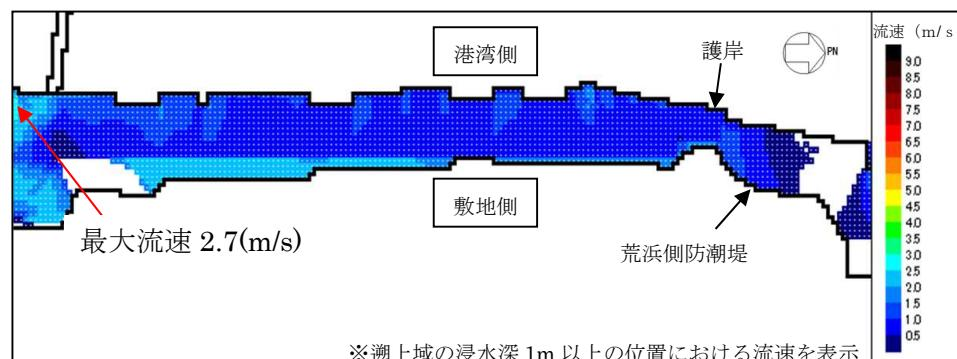
第16図 朝倉式に対応する基準津波1'の最大流速分布（荒浜側防潮堤直交方向）
