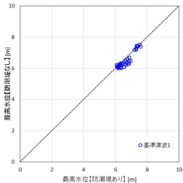
添付第 2-33 図 荒浜側防潮堤の有無に対する取水口前面水位比較
