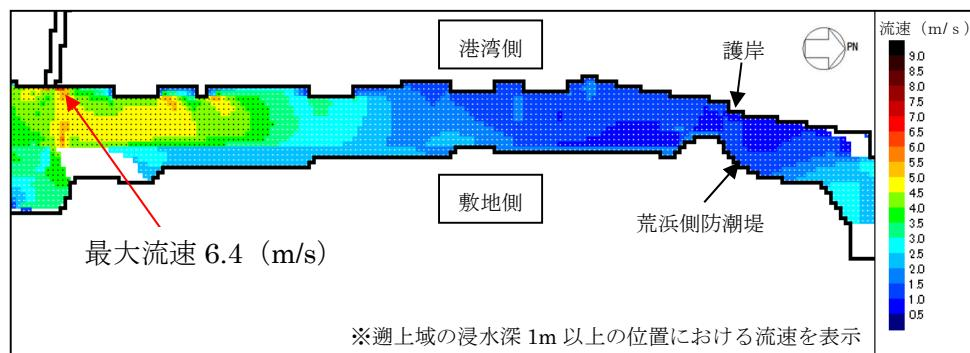
第2図 基準津波1' の最大流速分布図
