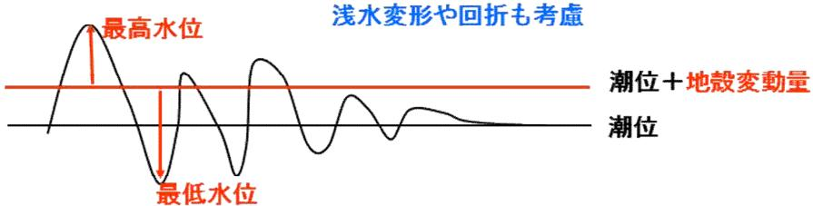
添付第 6-6 図 地殻変動量の概念図
