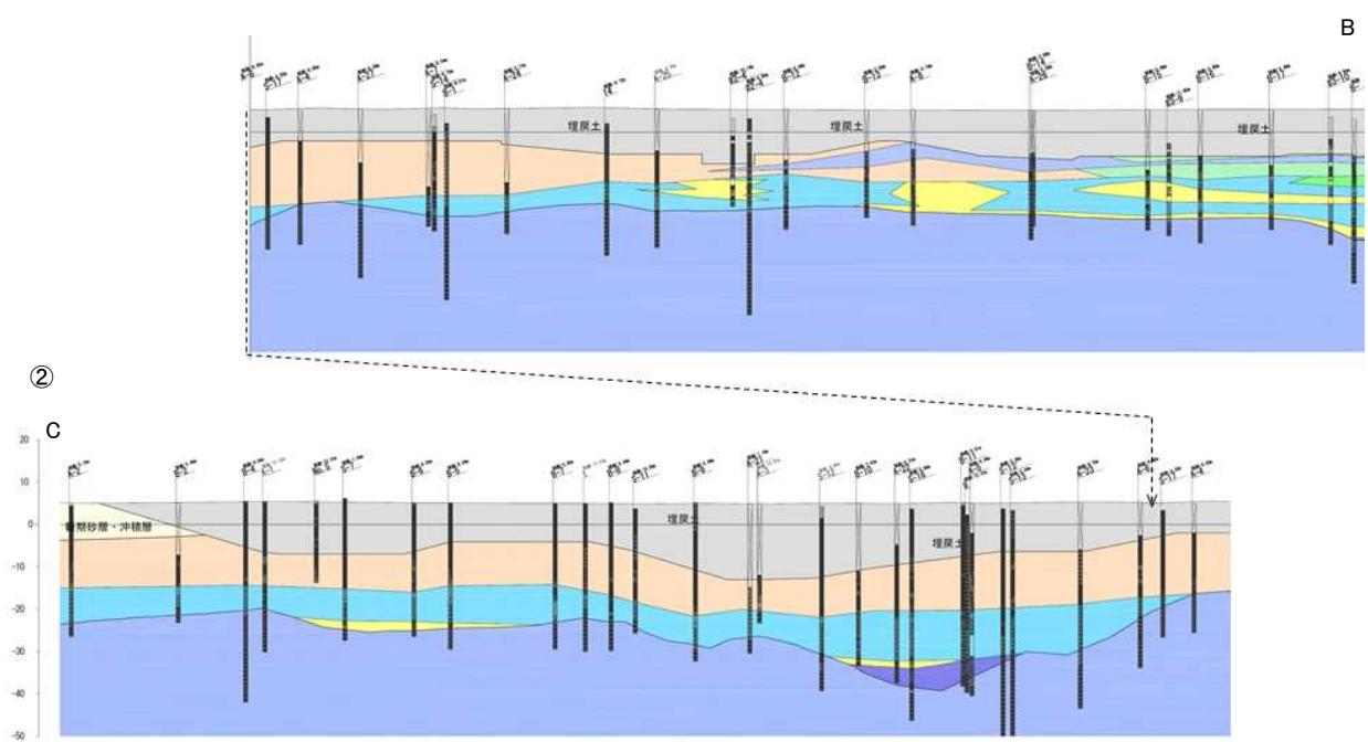
添付第 2-5 図(3) 地質断面図 (荒浜側 ②-②' (B-C) 断面)
