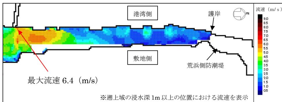
第3図 基準津波3 の最大流速分布図
