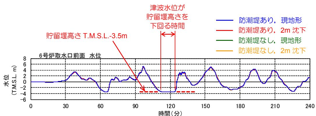
添付第 2-38 図 防潮堤及び沈下・斜面崩壊の有無に対する水位時刻歴波形の比較
