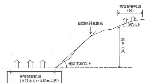
図X.1 急傾斜地崩壊危険箇所の要件
