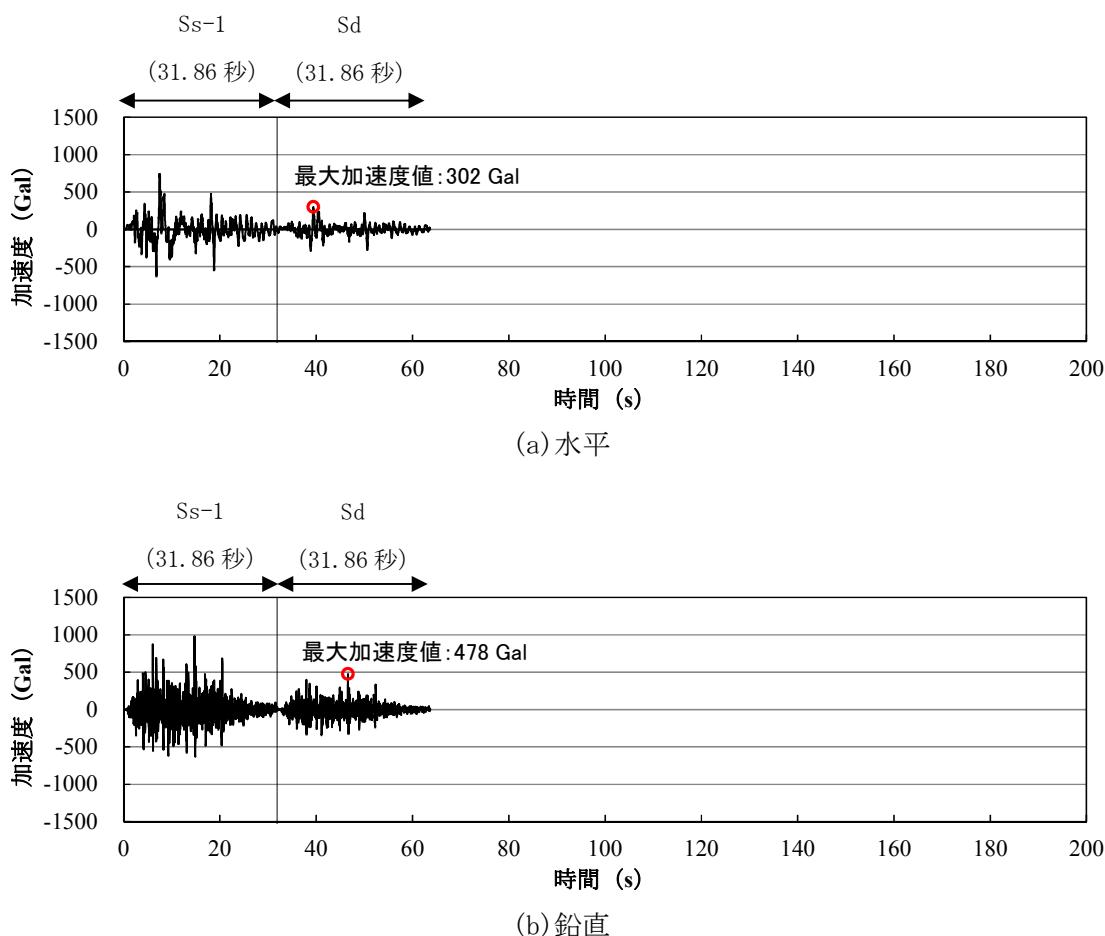
第 17 図 上部工重心位置での加速度応答 (Ss-1⇒Sd)
