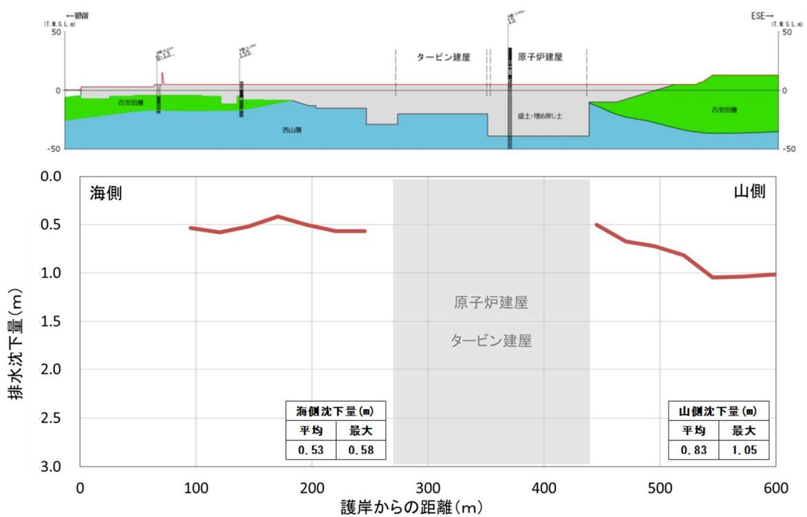
添付第2-8図(2) 沈下量 (2号炉汀線直交断面)
