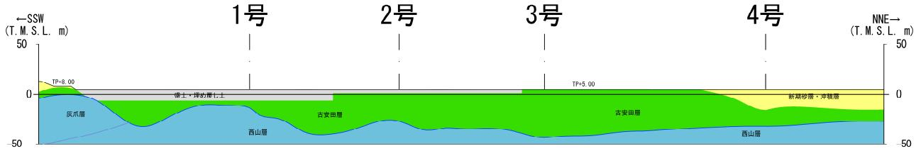
添付第 2-7 図(3) 地質断面図（原子炉建屋山側 汀線平行断面図）
