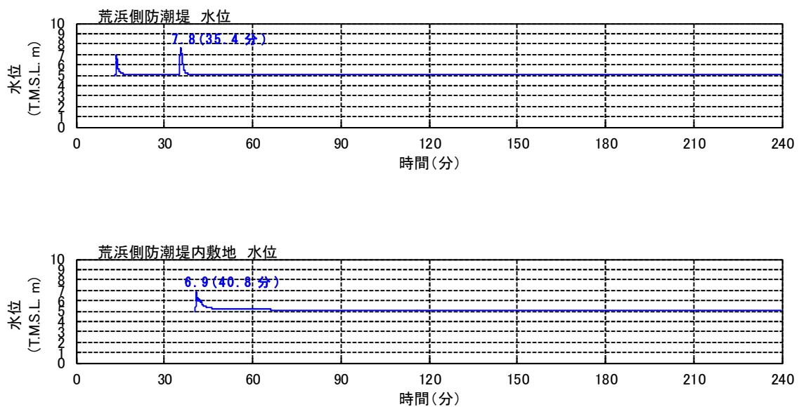
第 1.6-2-3 図 入力津波の時刻歴波形（荒浜側遡上域）
