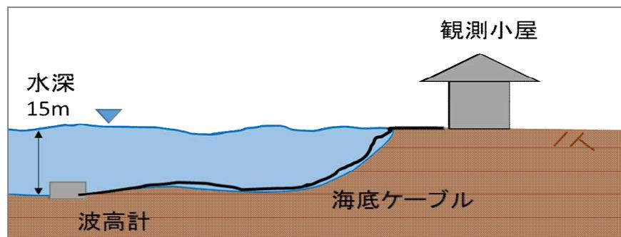
添付第 5-4 図 超音波式沿岸波高計の概念図
