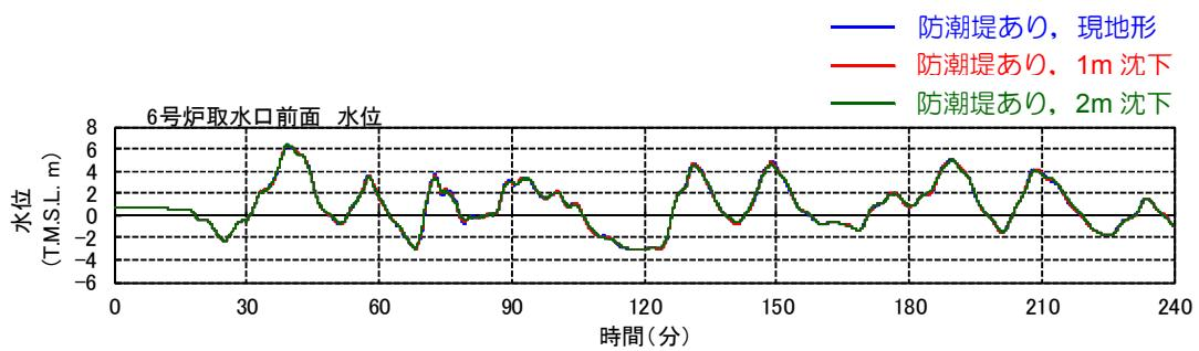
1) 基準津波 1, 6号炉取水口前面
