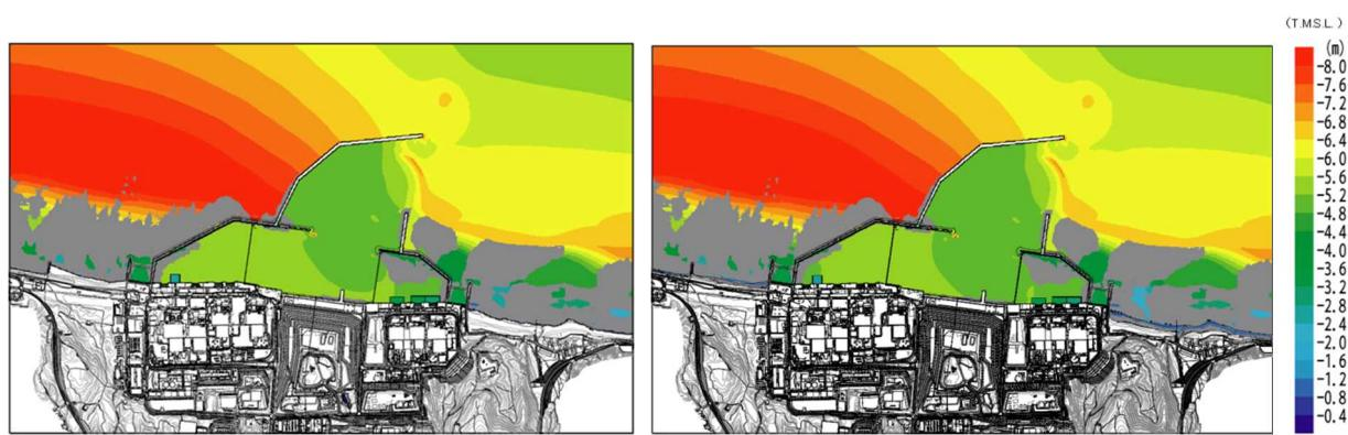
1) 防潮堤あり／沈下・斜面崩壊なし
