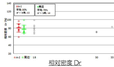
N値及び物理特性の比較 荒浜側 A-2（洪積砂層 I）
