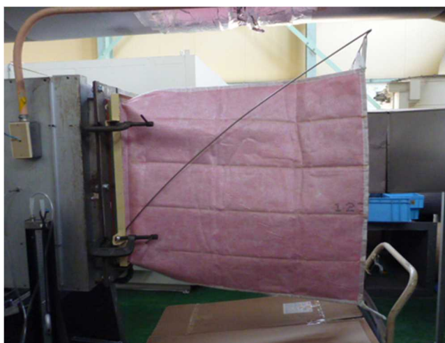
図 7-2 バグフィルタの耐荷重試験の様子
