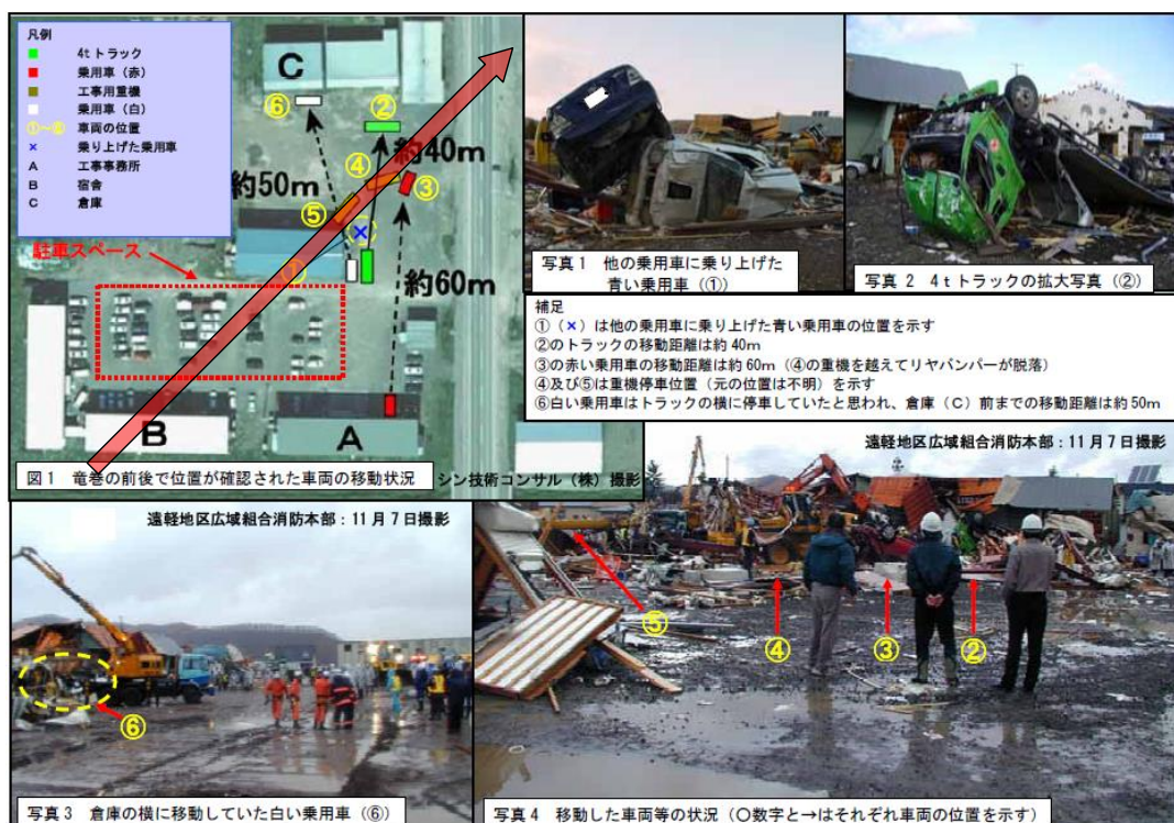
図27 佐呂間竜巻(2006.11.7)による被災状況(工事事務所敷地内の車両被災) (25) 文献(24)で示されている竜巻被害の方向を で加筆
