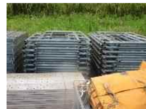
③-42 仮設足場枠組材
