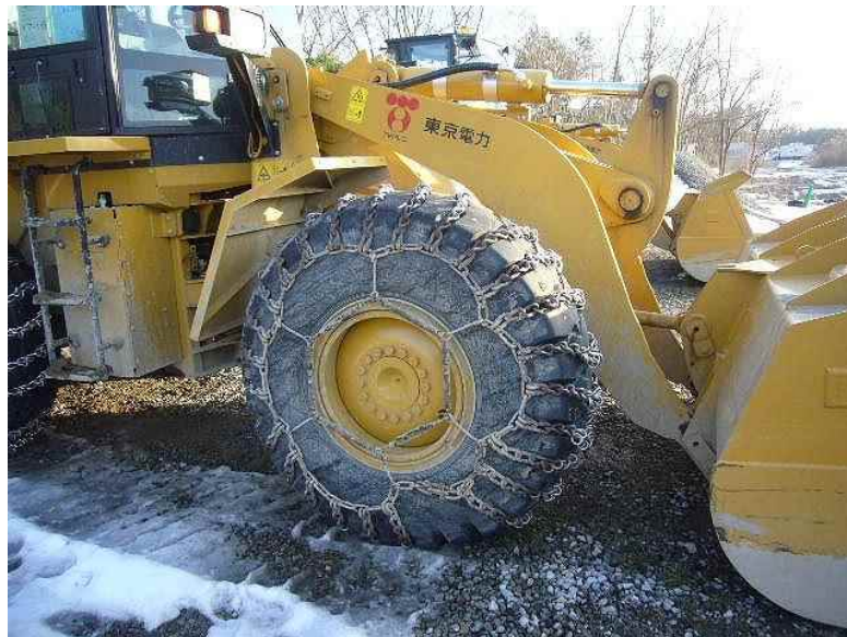
重機の凍結路面の滑り防止対策
