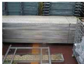
③-41 仮設足場板
