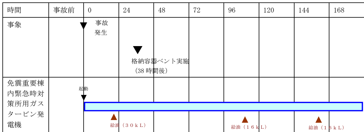
参考図 9.1-2 免震重要棟内緊急時対策所用ガスタービン発電機の給油タイミング
