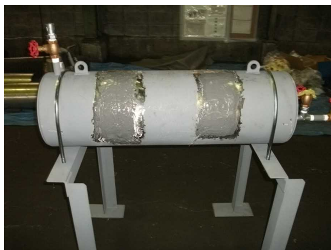
第 2.1.2-6 図 ベロメタル補修後の耐圧試験概要
