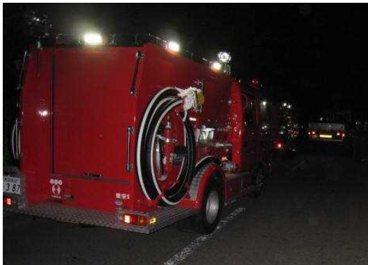
車両の作業用照明
