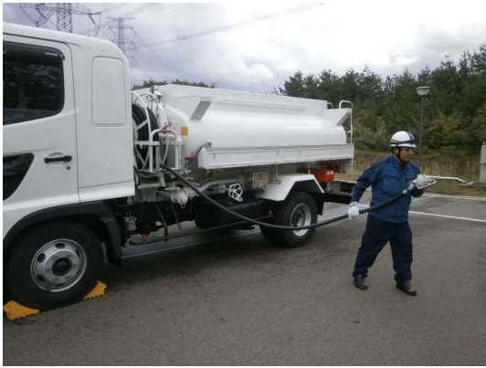
タンクローリへ給油ホースの展長
