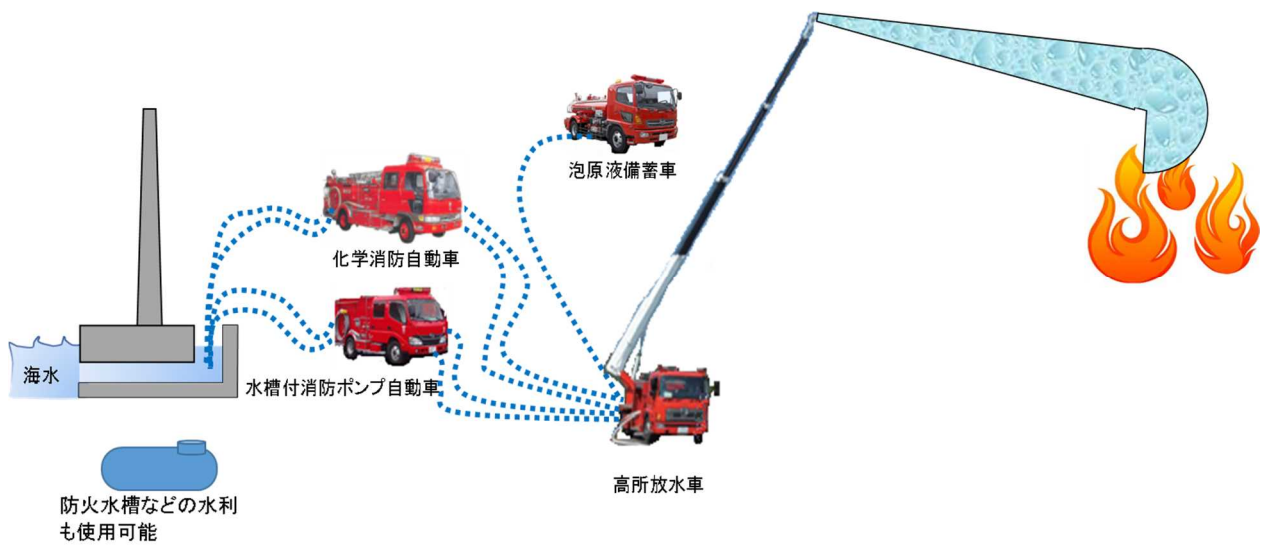
高所放水車による泡消火
