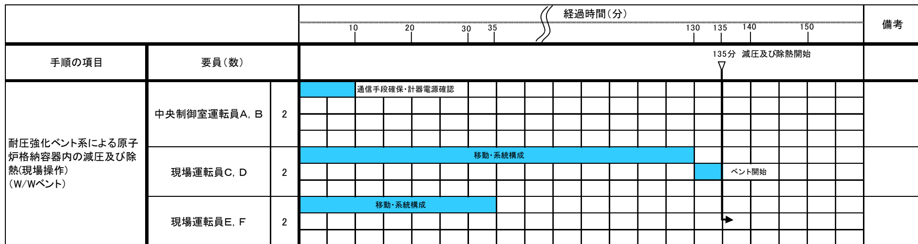
図 1.5.38 耐圧強化ベント系による原子炉格納容器内の減圧及び除熱(W/Wベント) タイムチャート (現場操作)
