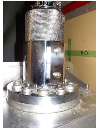
ユニハンドラー弁のリンク機構
