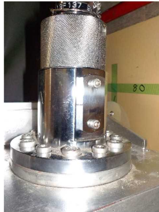
ユニハンドラー弁のリンク機構
