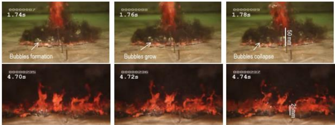
図付 4-8 PULiMS 実験 E4 ケースの溶融物拡がり挙動のスナップ写真 [21]
