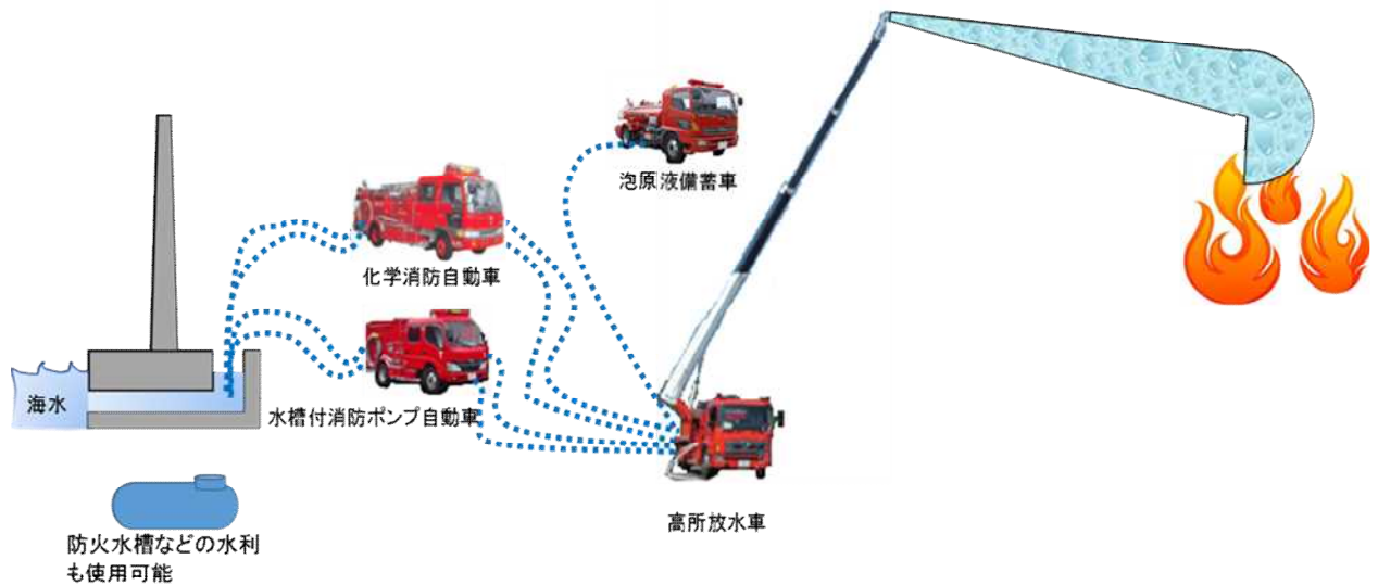
図 8-1 高所放水車による初期消火
