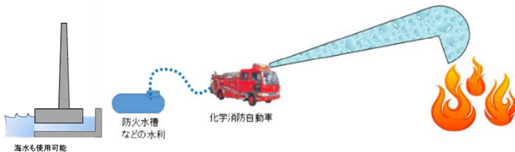
図 8-2 化学消防車による初期消火
