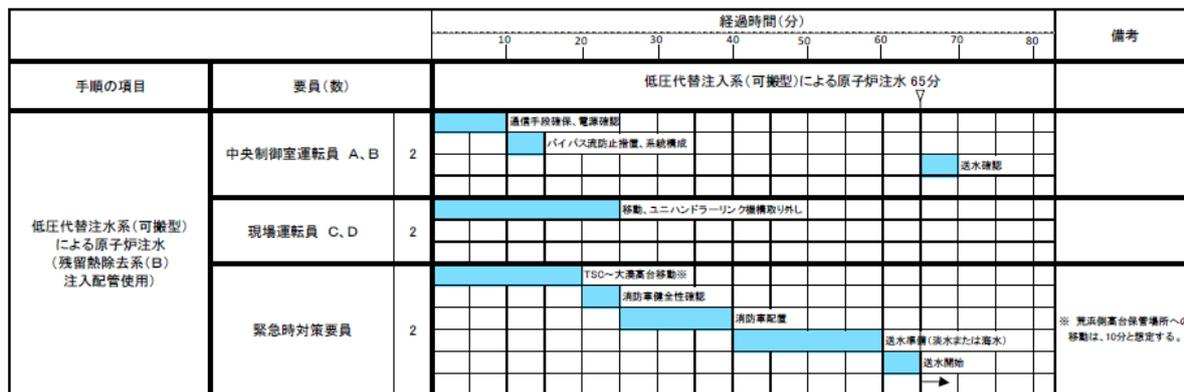
図 3.4-4 低圧代替注水系（可搬型）による原子炉注水（残留熱除去系(B)注入配管使用）のタイムチャート\*
