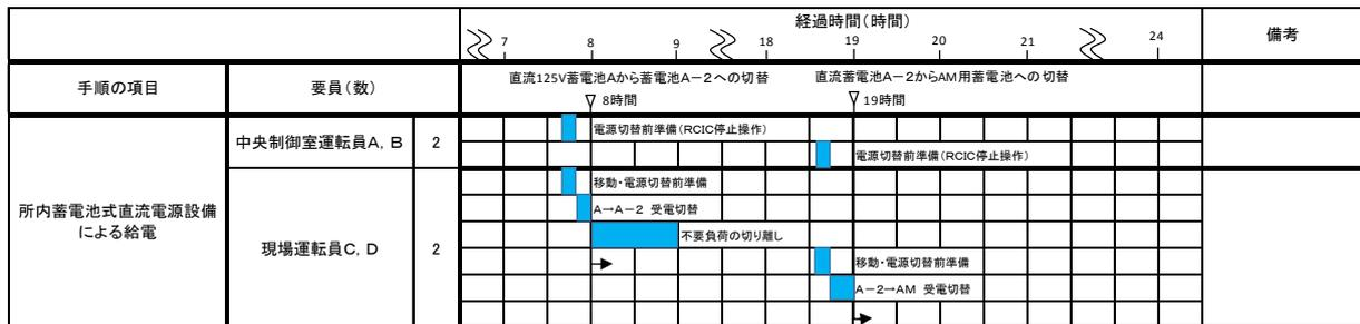
図 3.14-26 所内蓄電池式直流電源設備による電源供給（蓄電池 A, A-2, AM 用蓄電池切り替え）のタイムチャート（6号炉の例）
