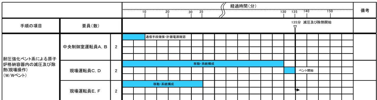
図 3.5-6 耐圧強化ベント系による除熱 (W/W ベント) のタイムチャート\*
