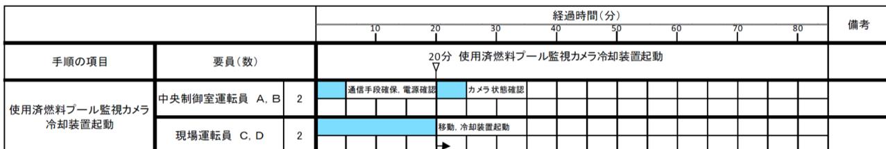
図 3. 11-12 使用済燃料貯蔵プール監視カメラ用空冷装置のタイムチャート\*
