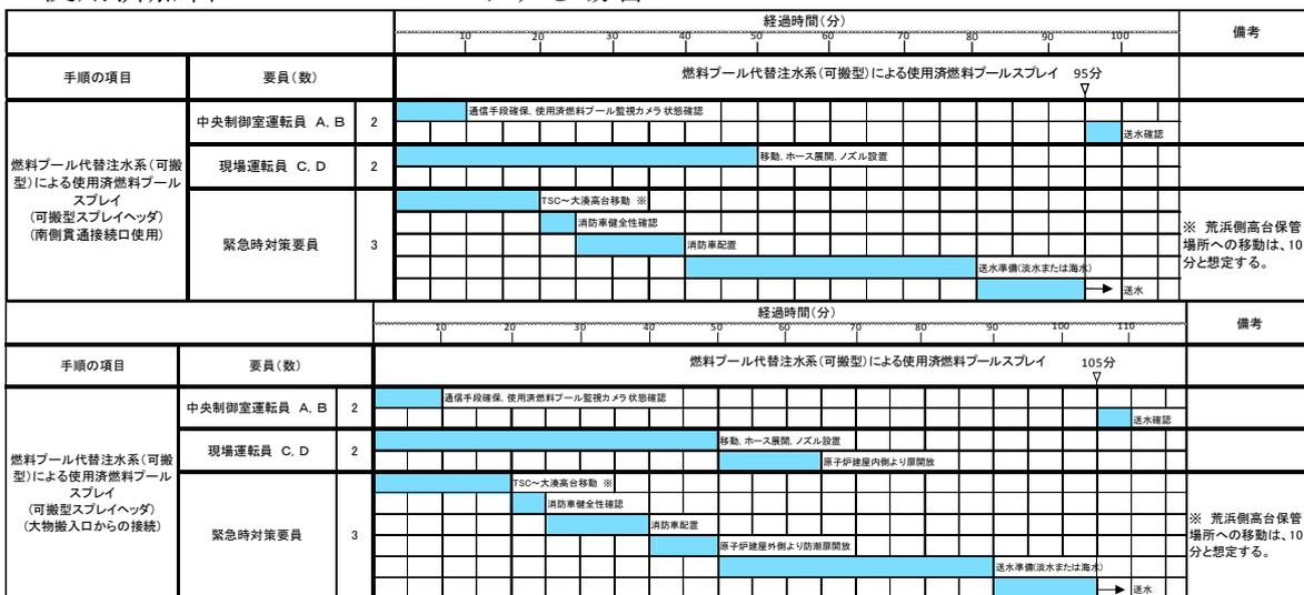
図 3.11-3 燃料プール代替注水系（可搬型スプレイヘッド）のタイムチャート\*
