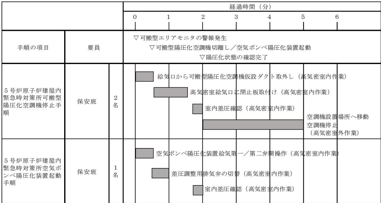
図 3. 18. 2. 6. 3-4 5号炉原子炉建屋内緊急時対策所可搬型陽圧化空調機停止, 及び, 5号炉原子炉建屋内緊急時対策所空気ポンベ陽圧化装置起動手順のタイムチャート\*
