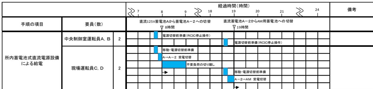
図 3.14-32 可搬型直流電源設備による電源供給のタイムチャート
