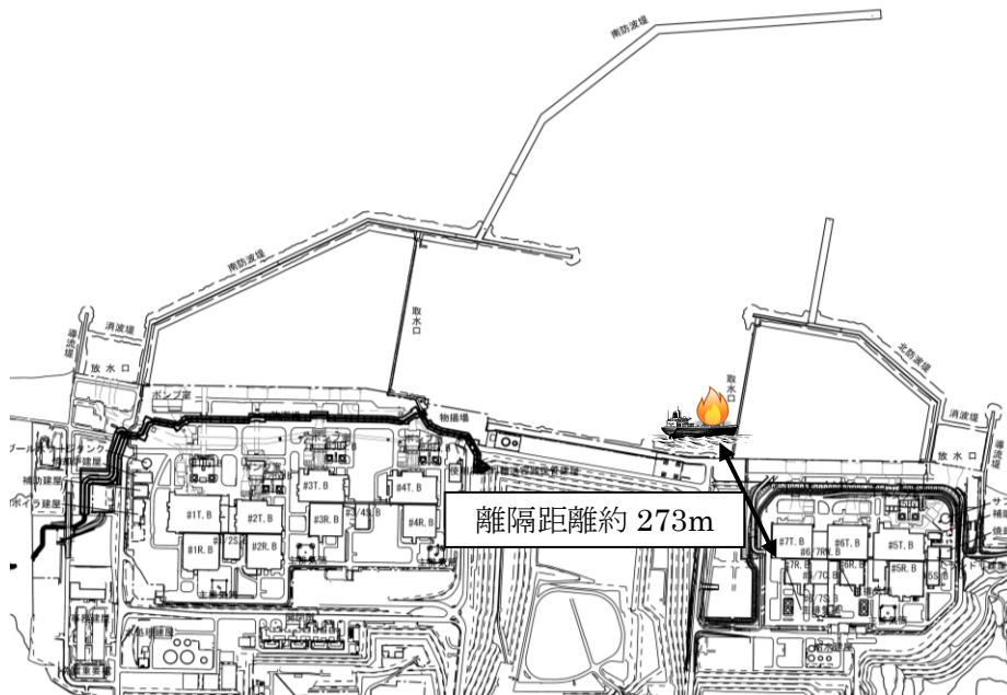
第 2.2.2.2-3 図 漂流船舶の離隔距離
