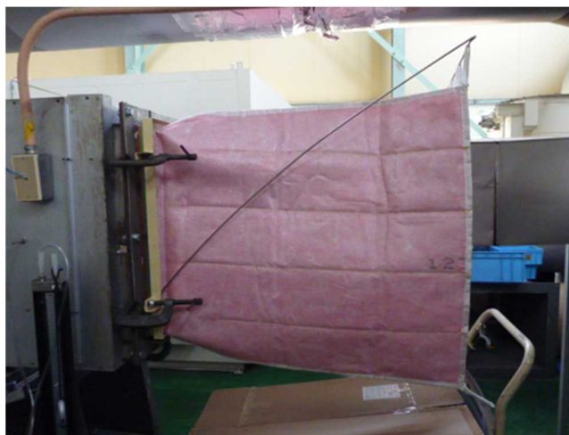
図 7-2 バグフィルタの耐荷重試験の様子
