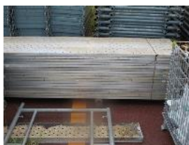
③-41 仮設足場板
