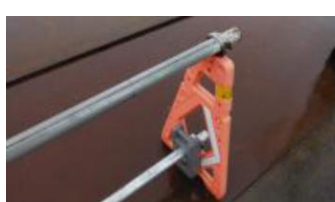
⑥-8 鋼製車止め (単管バリケード)
