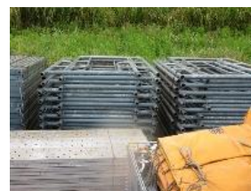
③-42 仮設足場枠組材
