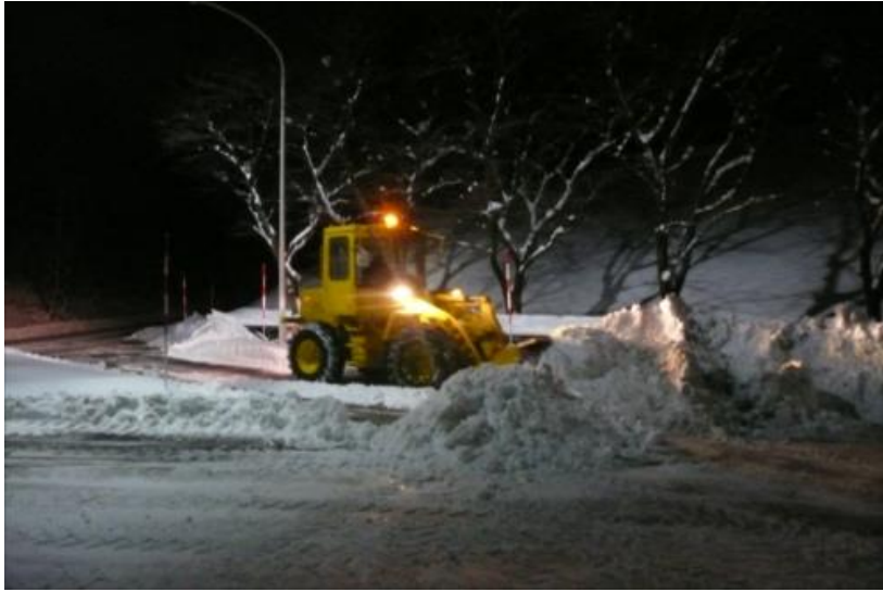
重機による除雪作業(1)
