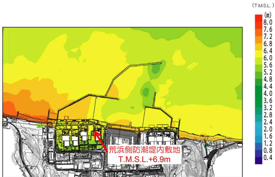
添付第 2-47 図(3) 基準津波 1 における最高水位分布 (防波堤あり, 防潮堤なし, 現地形)
