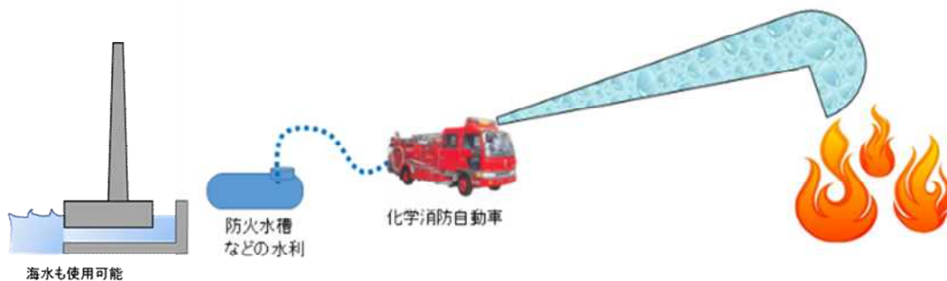
図 8-2 化学消防自動車による泡消火
