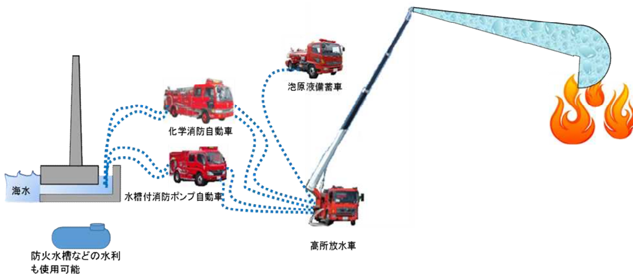
図 8-1 高所放水車による泡消火
