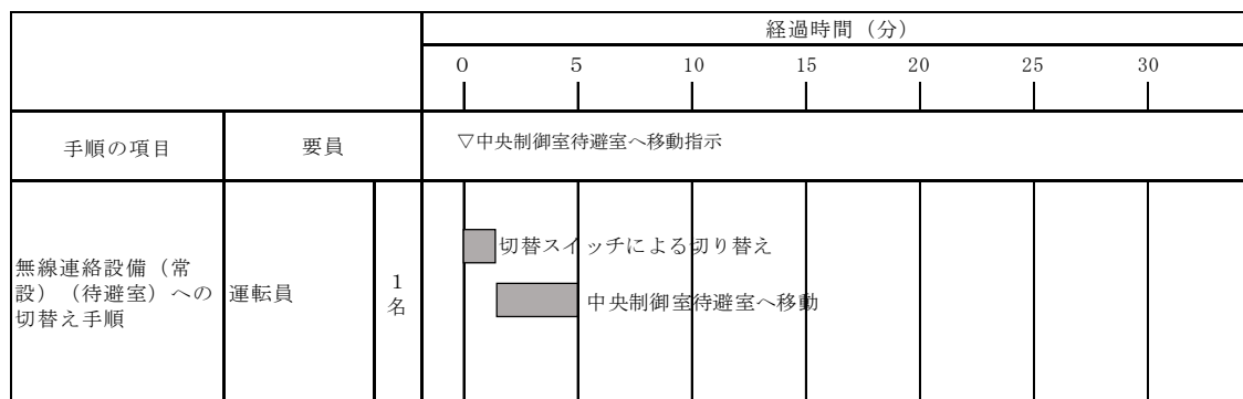
図 3.16-5 無線連絡設備 (常設) (待避室) の待避室側への切り替えタイムチャート*
