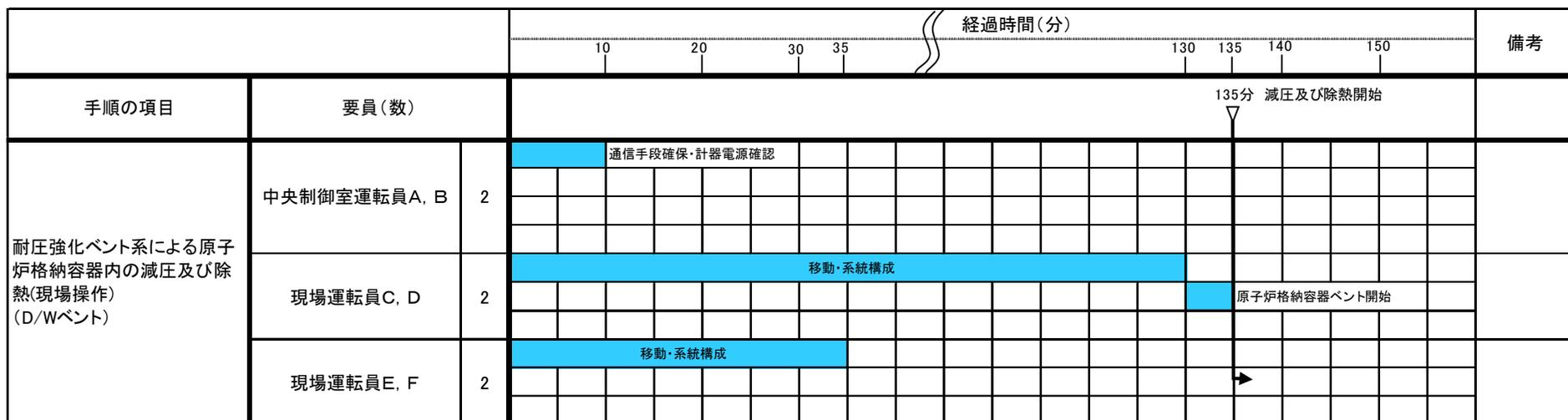
図 1.5.39 耐圧強化ベント系による原子炉格納容器内の減圧及び除熱(D/Wベント) タイムチャート (現場操作)
