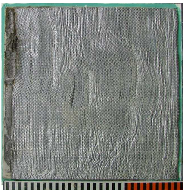
写真 3.4.11 スケール影響試験後の供試体状況 ケース 2-6 (保護層表面)
