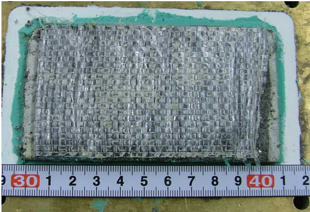
写真 3.4.1 スケール影響試験後の供試体状況 ケース 2-1 (保護層表面)
