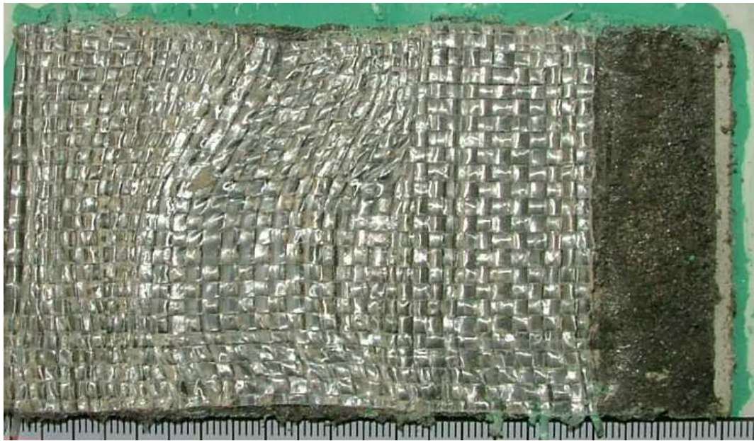
写真 3.4.5 スケール影響試験後の供試体状況 ケース 2-3 (保護層表面)
