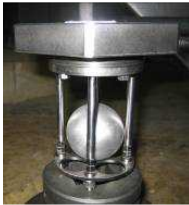
第 4.2-14 図 フロート式止水治具の外観及び構造例
