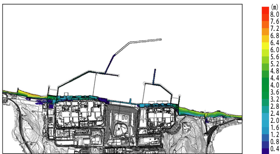
添付第 2-57 図 基準津波 3 における最大浸水深分布 (防波堤あり，防潮堤あり，現地形)
