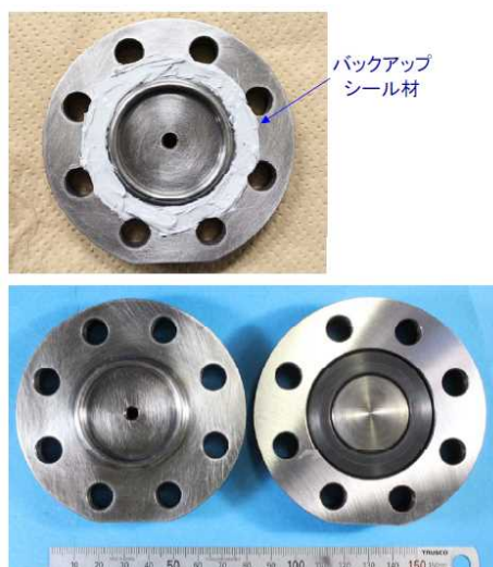
図3-13 「改良EPDM+バックアップシール材」組合せ試験装置
