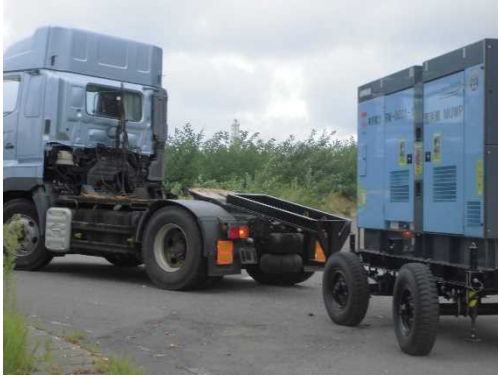
仮設発電機移動
