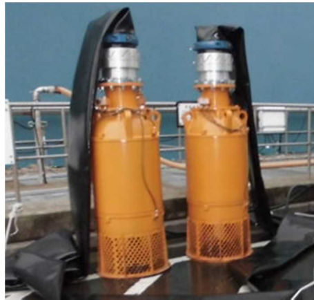
代替原子炉補機冷却海水ポンプ
