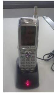
電力保安通信用電話設備 (PHS 端末)
