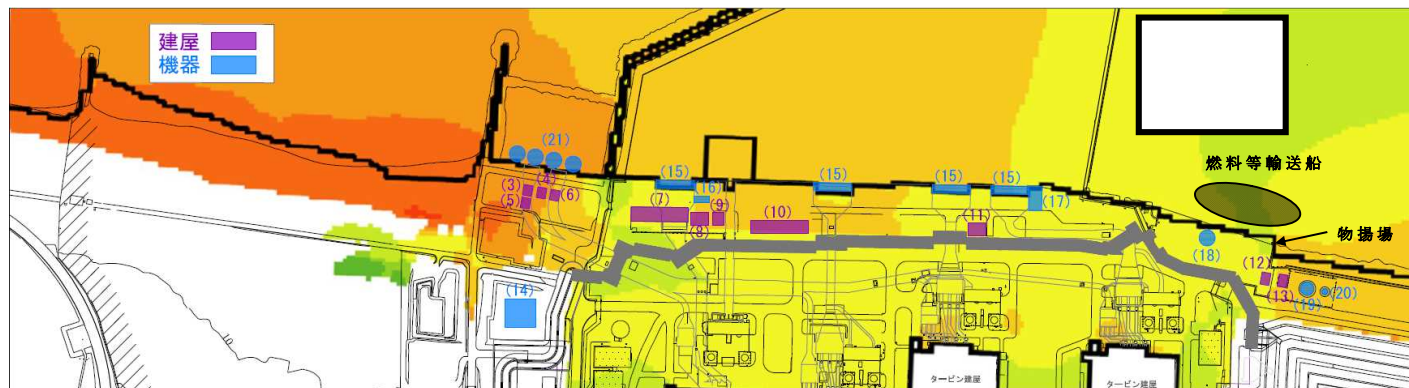
第 2.5-14-3 図 漂流物調査結果（発電所構内荒浜側護岸部詳細）
