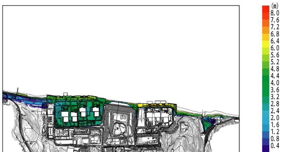
添付第 2-59 図 基準津波 1 における最大浸水深分布 (防波堤なし, 防潮堤なし, 2m 沈下, 斜面崩壊)
