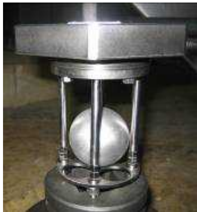
第 4.2-14 図 フロート式止水治具の外観及び構造例
