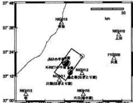
図1 探索範囲とする断層面(矩形)と、本震と余震の震央位置・メカニズム解(F-net)、インバージョンに用いた観測点(△)位置。
