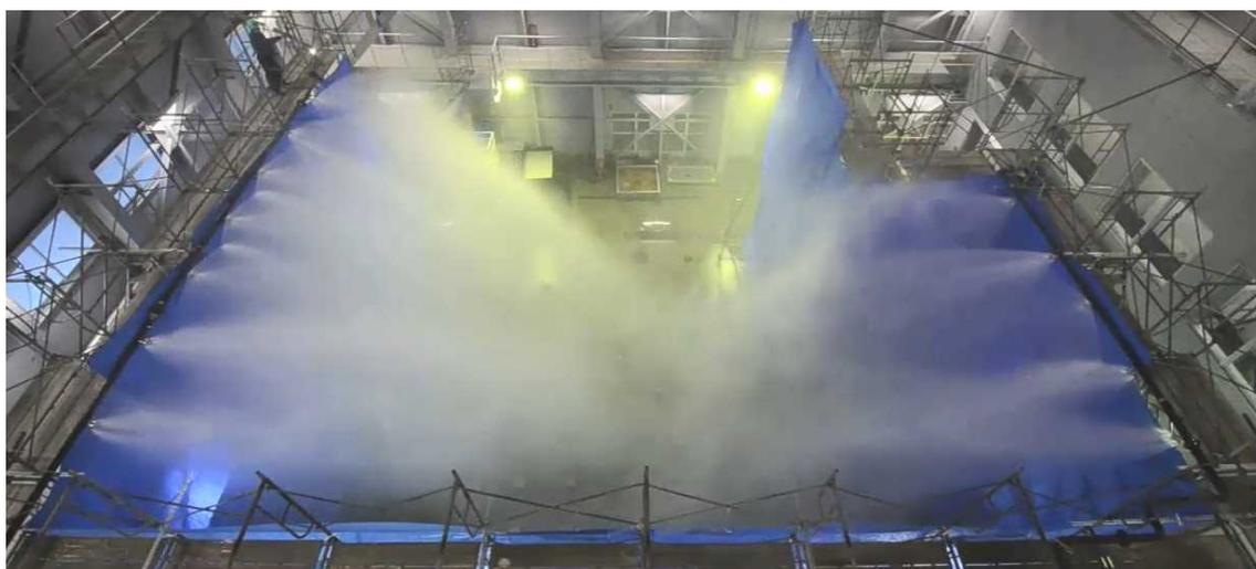
図9 スプレイ状態の試験状況（スプレイ量：132m<sup>3</sup>/h）
