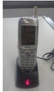
電力保安通信用電話設備 (PHS 端末)
