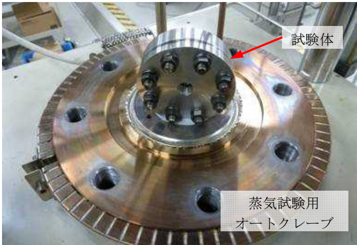
図4 蒸気暴露試験体設置状況
