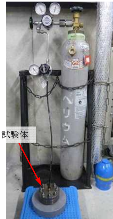
図5 He気密確認試験状況
