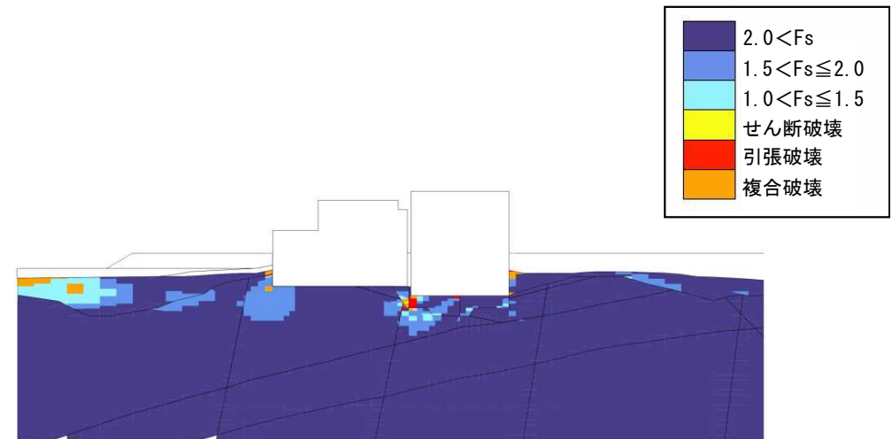
地盤の局所安全係数 (破壊表示は過去の履歴を考慮)
