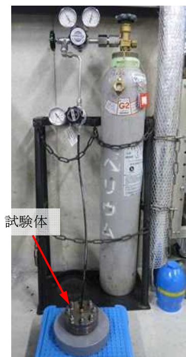
図5 He気密確認試験状況
