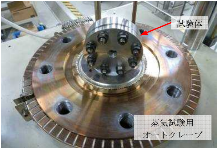
図 4 蒸気暴露試験体設置状況
