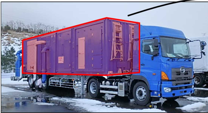
図 48-12-1 熱交換器ユニットの保管場所における転倒防止措置のイメージ
