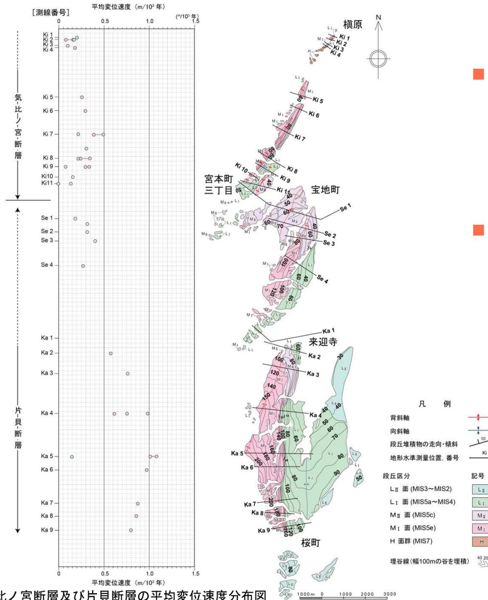
気比ノ宮断層及び片貝断層の平均変位速度分布図
