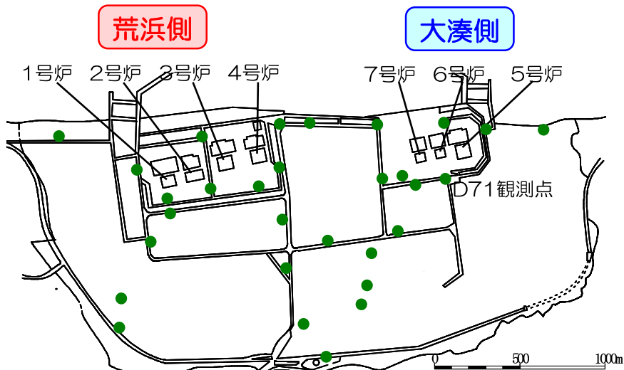
水平アレイ観測点（●：30地点）の配置図と基準点位置
