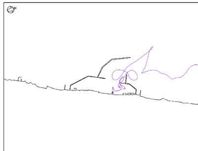
防波堤 2m 沈降
