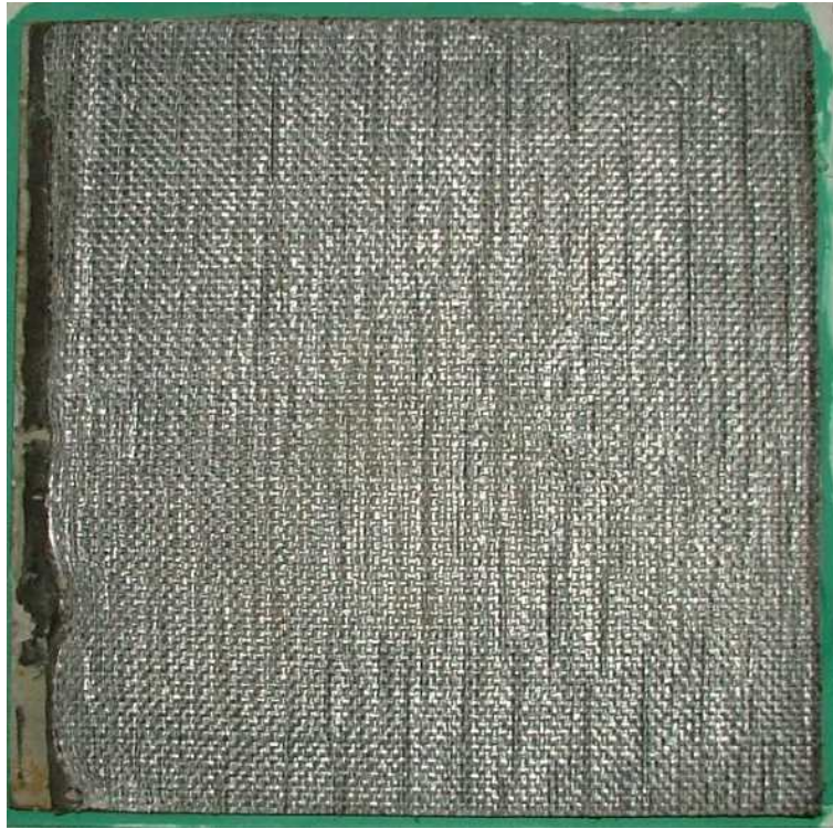
第 3.4.9 図 スケール影響試験後の供試体状況 ケース 2-4 (保護層表面)
