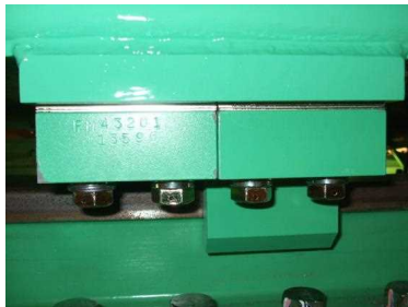
A : トロリ片爪脱線防止ラグの形状
