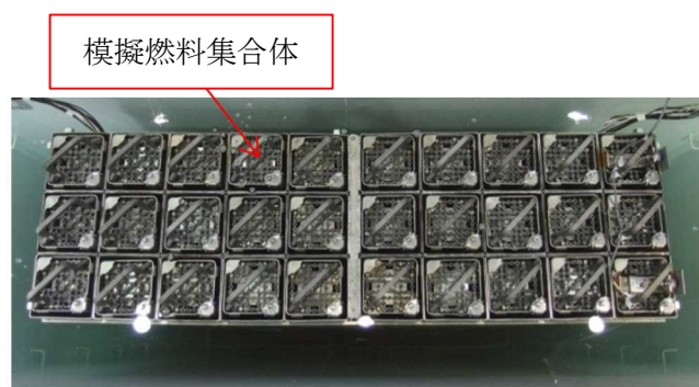
(2) 供試体の水槽内設置状況
