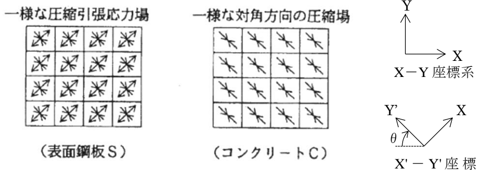
第 3-1 図 ひび割れ後の応力状態の仮定
