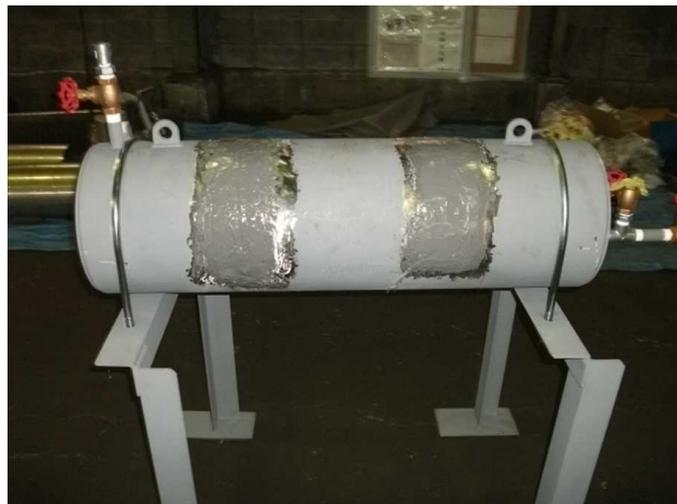
図 2.1.2-6 ベロメタル補修後の耐圧試験
