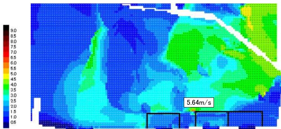
【防波堤なし】基準津波2(貯留堰方向)
