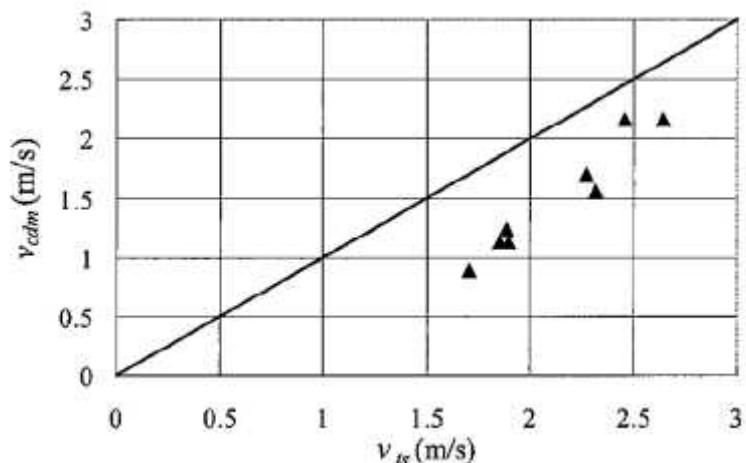
添付第 25-1 図 津波流速  $v_{ts}$  と最大漂流速度  $v_{cdm}$  の関係
