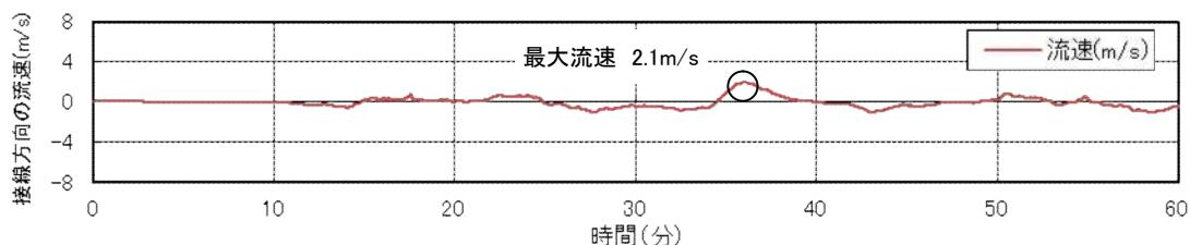
添付第 21-3-2 図 防波堤損傷時における基準津波 3 の流速（物揚場前面）
