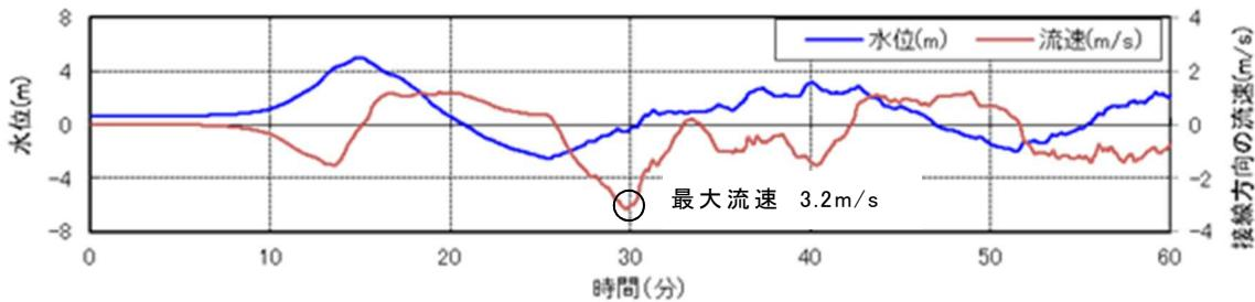
図 6-1 基準津波 3 の水位・流速（物揚場前面）
