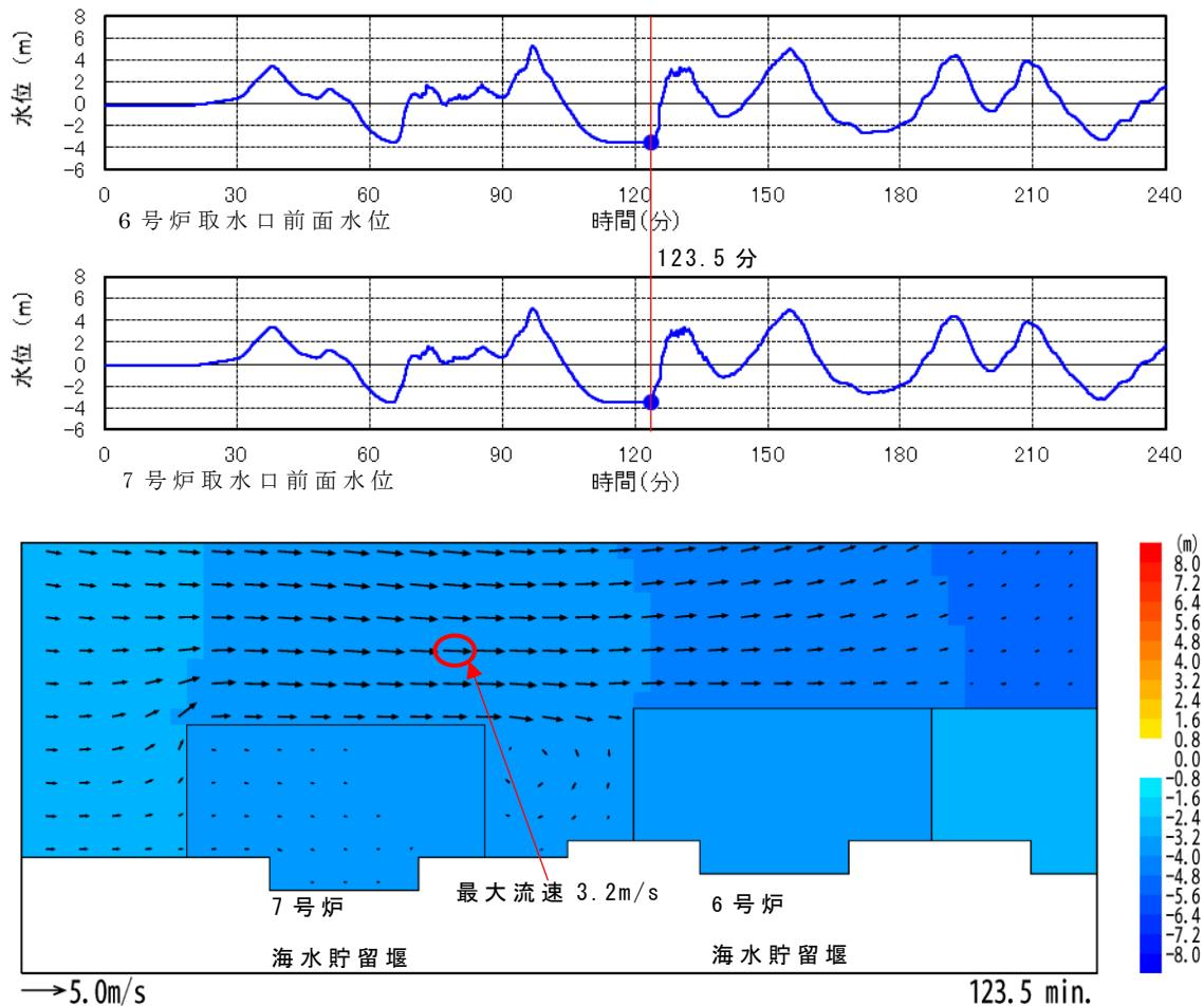
第1図 海水貯留堰越流直前の流向・流速分布
