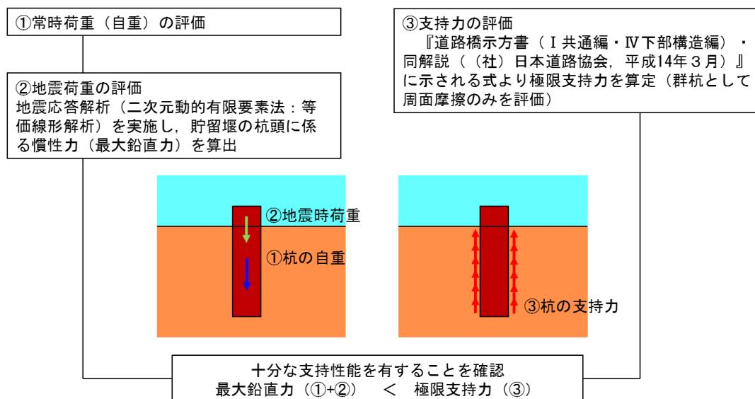
添付第31-4図 海水貯留堰の評価フロー
