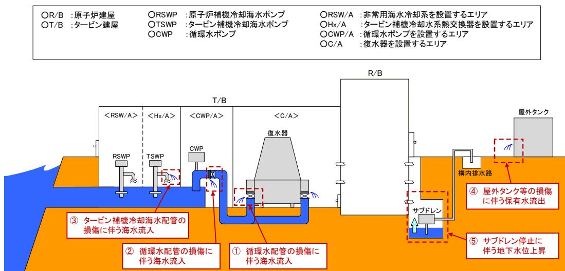
添付第12-1図 地震による溢水の概念図
