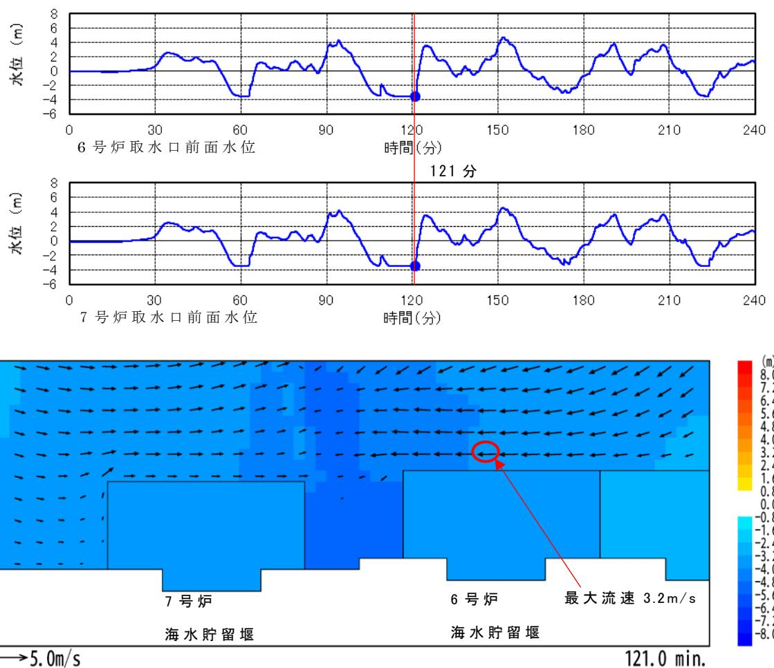
第1図 海水貯留堰越流直前の流向・流速分布
