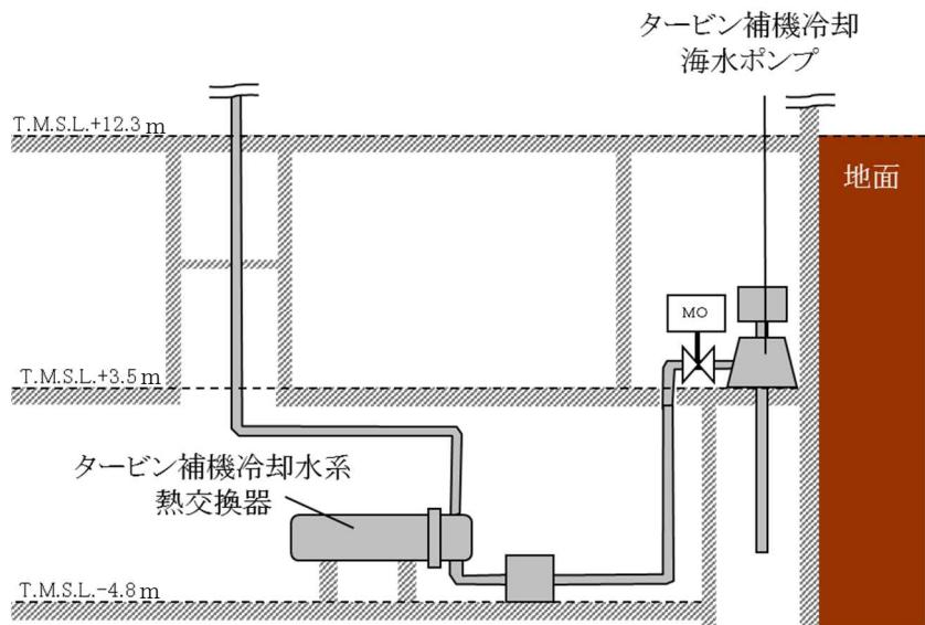
添付第 13-3 図 タービン補機冷却海水配管レイアウトイメージ (6号及び7号炉)
