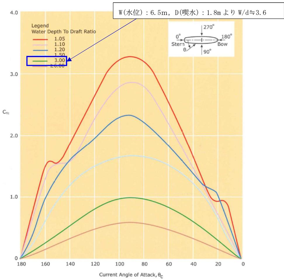
添付第 23-4 図 横方向流圧力係数 [ $C_{Yc}$ ] <sup>1)</sup>
