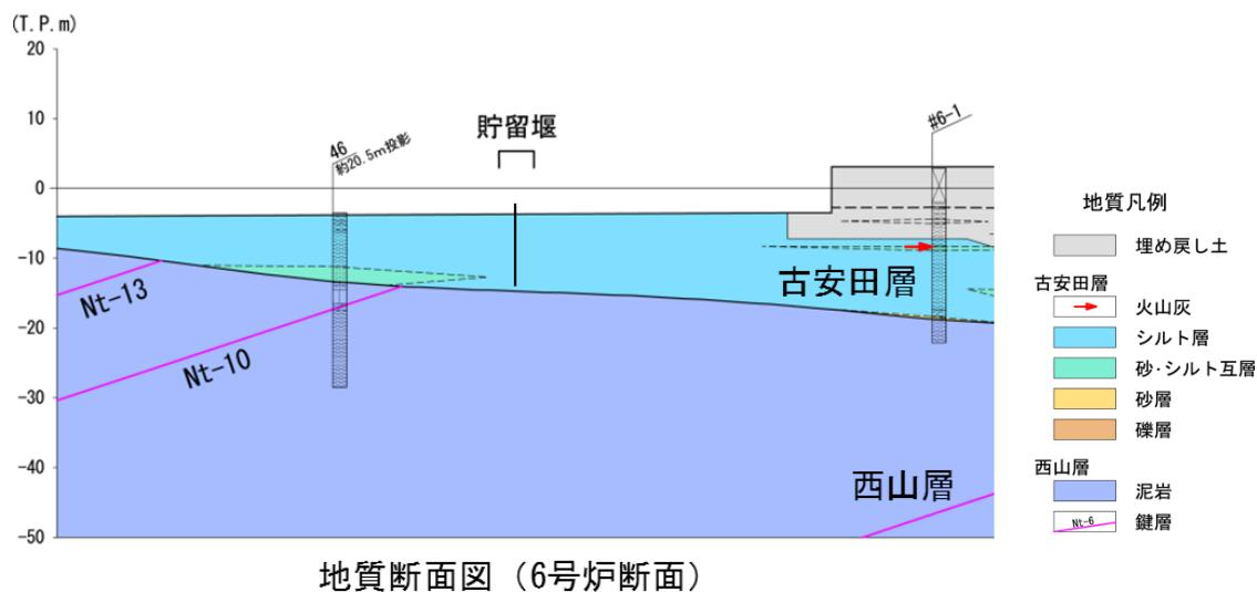
添付第 31-2 図 6 号炉海水貯留堰地質縦断図
