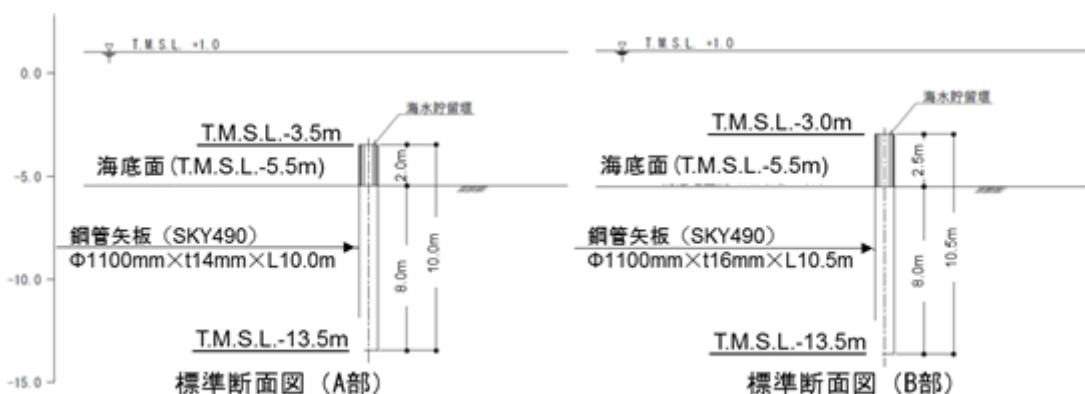
添付第 28-2 図 海水貯留堰の断面図
