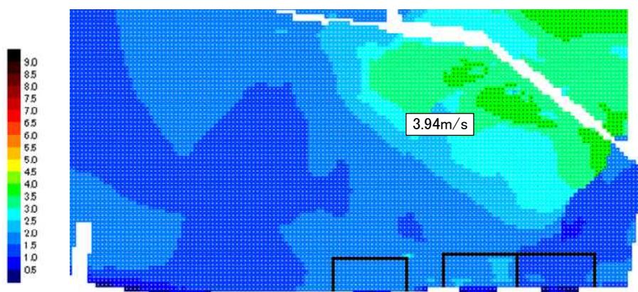
【防波堤なし】基準津波3(貯留堰方向)
