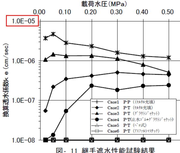
添付第 32-1 図 鋼管矢板継手部の遮水性能試験結果<sup>1)</sup>
