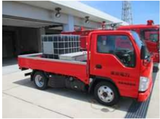
泡消火薬剤備蓄車
