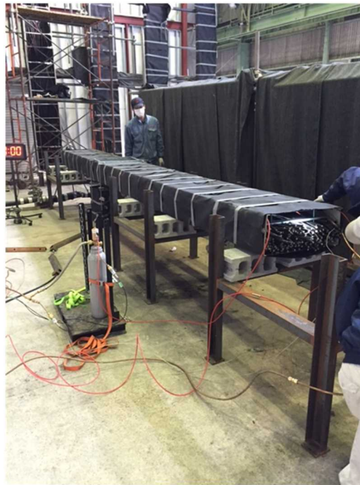
第 13 図：消火実証試験用（金属蓋なし）のケーブルトレイ外観
