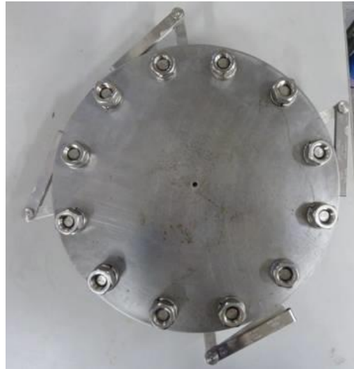
図7 変位付与状況 隙間ゲージを用いて所定の変位を加えた後、隙間ゲージを抜いて再締め付け
