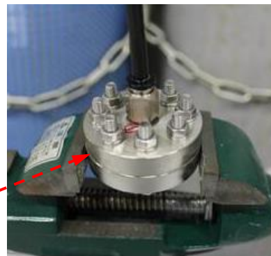
図4 気密確認試験状況
