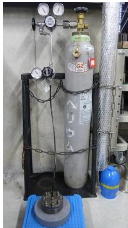
図 12 He 気密確認試験状況
