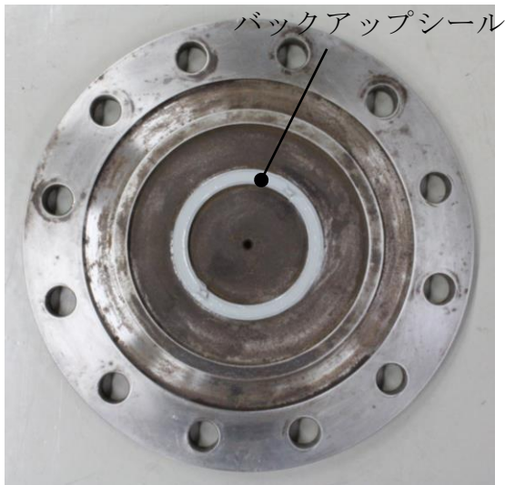
図6 バックアップシール材塗布状況 (1.5mm 厚さ)
