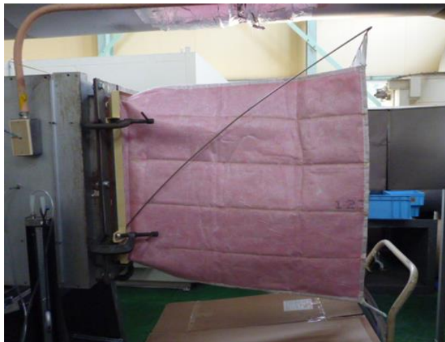
図7-2 バグフィルタの耐荷重試験の様子
