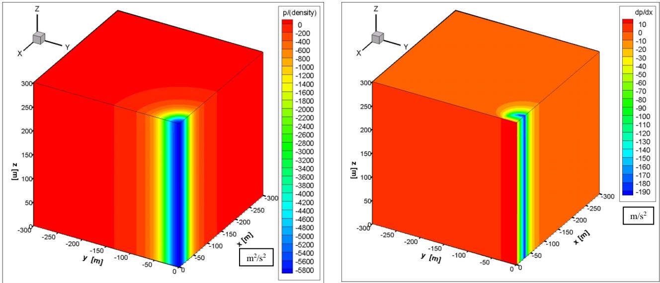
図5 最大接線風速  $V_{tm}=78\text{m/s}$  におけるランキン渦モデルの（左）圧力分布と（右）圧力の  $x$ -方向空間微分値
