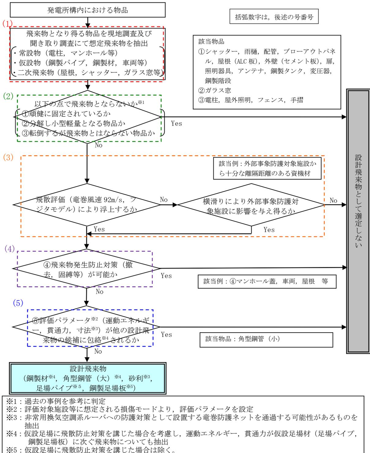
図 3.3.1 設計飛来物の選定フロー
