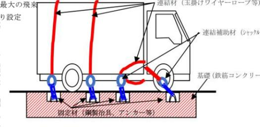
図 3.2.1.3 車両固縛のイメージ
