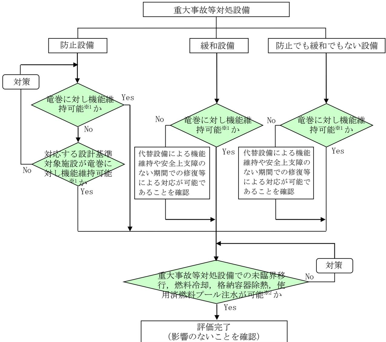
※1：屋内設備については、当該設備を内包する建屋（原子炉建屋、タービン建屋、コントロール建屋、廃棄物処理建屋）の影響評価を実施し、安全機能が維持されるかを確認。
