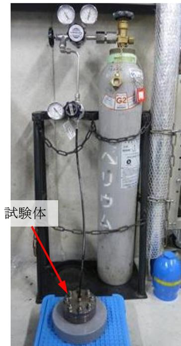
図5 He気密確認試験状況
