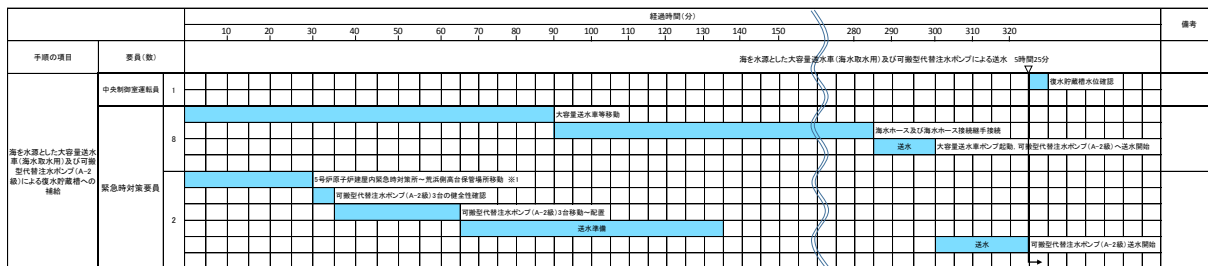
図 3.13-20 海を水源とした大容量送水車（海水取水用）及び可搬型代替注水ポンプ（A-2 級）による復水貯蔵槽への供給のタイムチャート*
