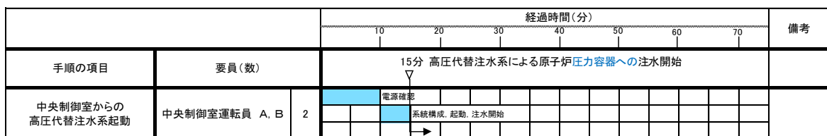
図 3.2-2 中央制御室からの高圧代替注水系起動のタイムチャート*
