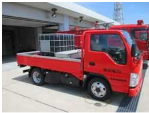
泡消火薬剤備蓄車
