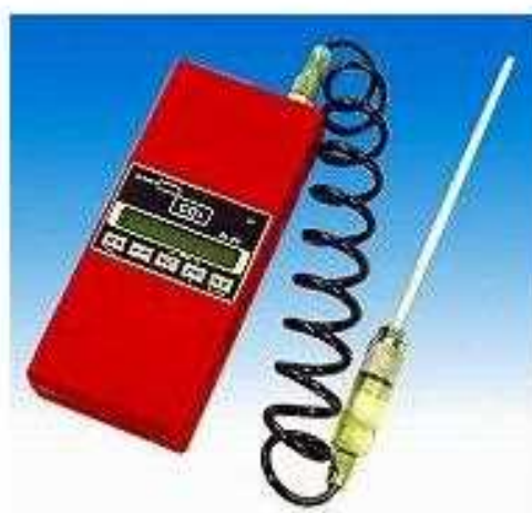
図 61-5-12 二酸化炭素濃度計の概略図
